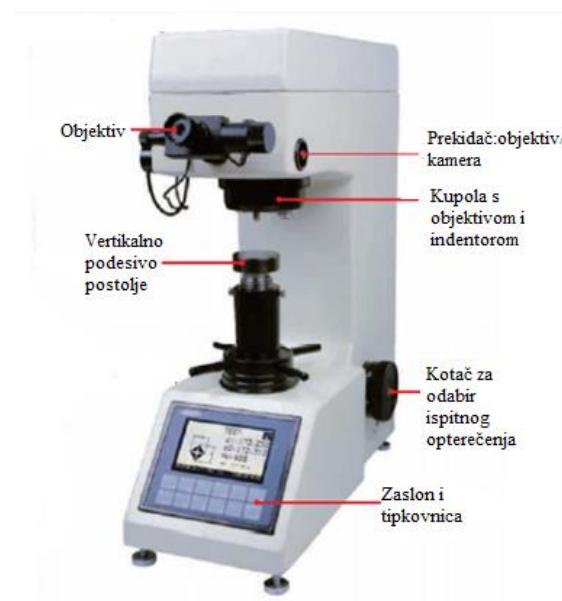
S1.3.6. Vickersov uređaj za ispitivanje tvrdoće [7]
