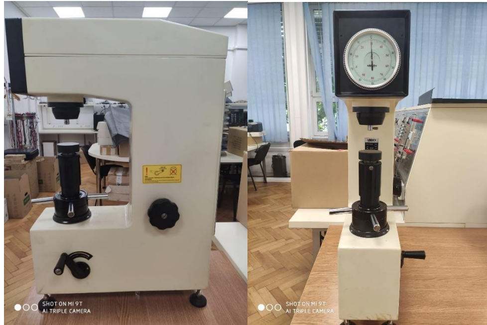
Sl.4.1 Rockwellov uređaj za ispitivanje tvrdoće [10]
