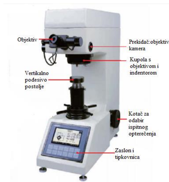
Sl.3.6. Vickersov uređaj za ispitivanje tvrdoće [7]
