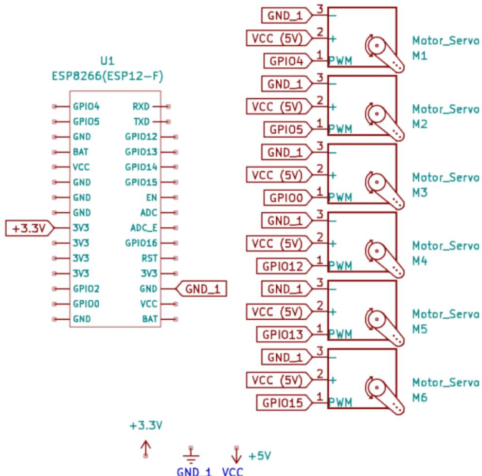
Sl. 3.13 Shema spoja robotske ruke i napajanja
