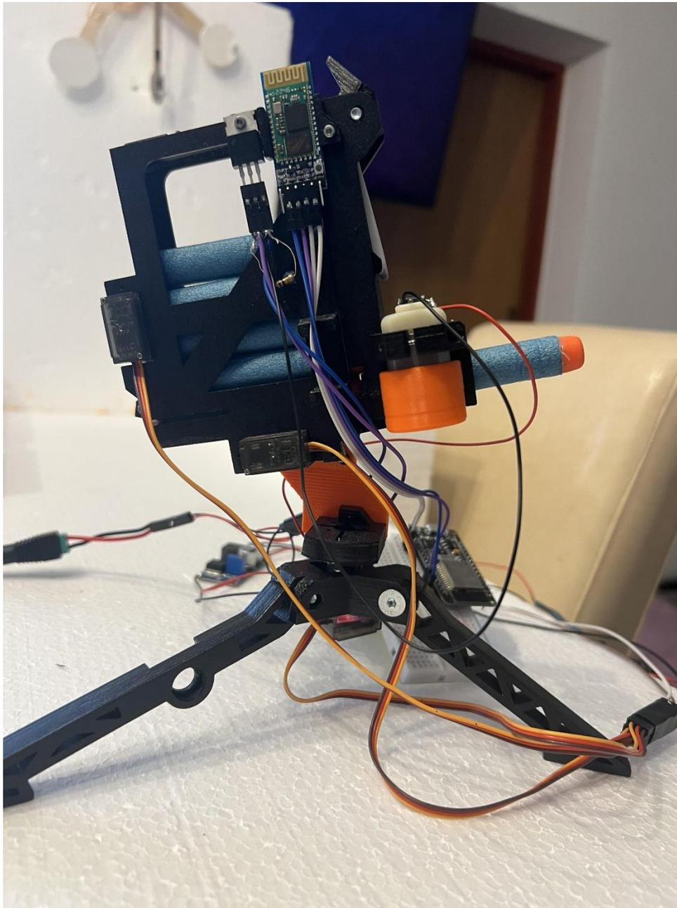
**Slika 3.12.** *Prikaz ispućavanja metka pomoću dva istosmjerna motora.*
