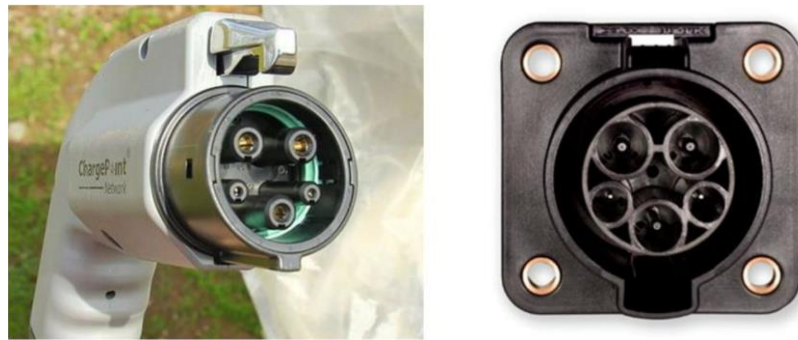
Slika 3.1.2.2. SAEJ1772 konektor: utikač lijevo i utičnica desno.[10]
