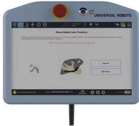
Slika 4.11. Interaktivni ekran za upravljanje robotom
