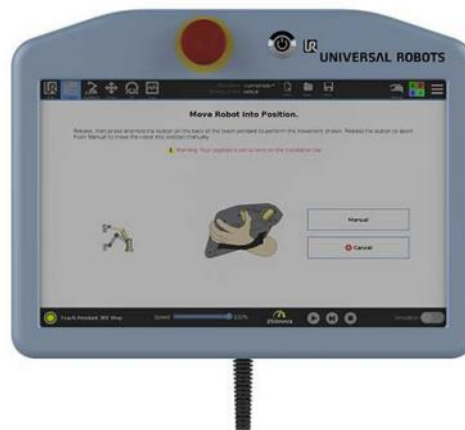
Slika 4.11. Interaktivni ekran za upravljanje robotom
