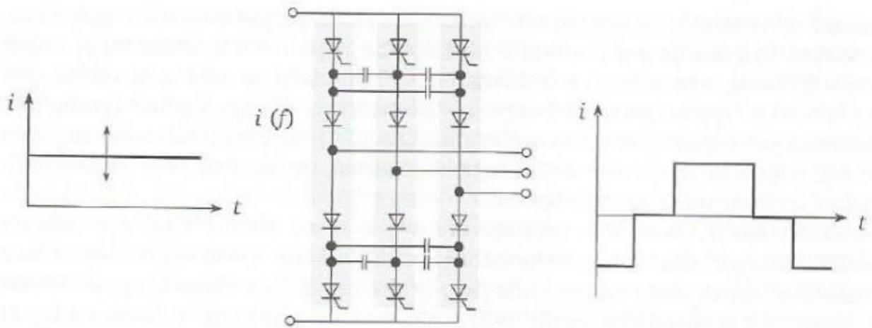
**Slika 4.21.** Izmjenjivač s promjenjivom strujom strujnog međukruga [6]
