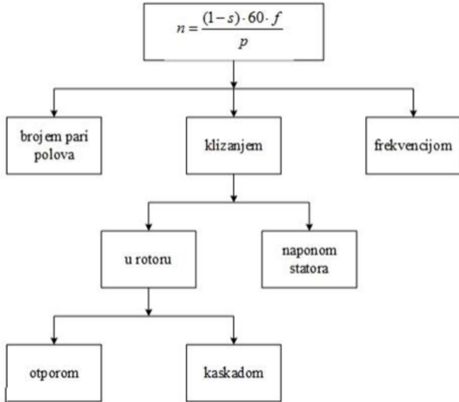
**Slika 2.9.** Načini upravljanja brzinom vrtnje asinkronog stroja [7]
