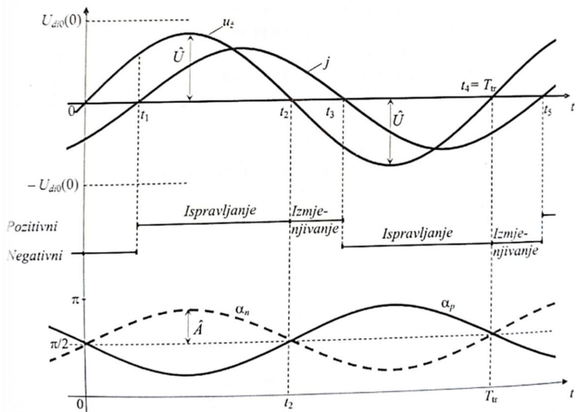
**Slika 4.4.** Karakteristični valni oblici savršenog ciklopretvarača [8]
