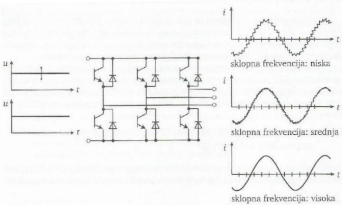
**Slika 4.22.** Izmjenjivač s utisnim konstantnim ili promjenjivim naponom te utjecaj sklopne frekvencije na izlazni valni oblik struje [6]
