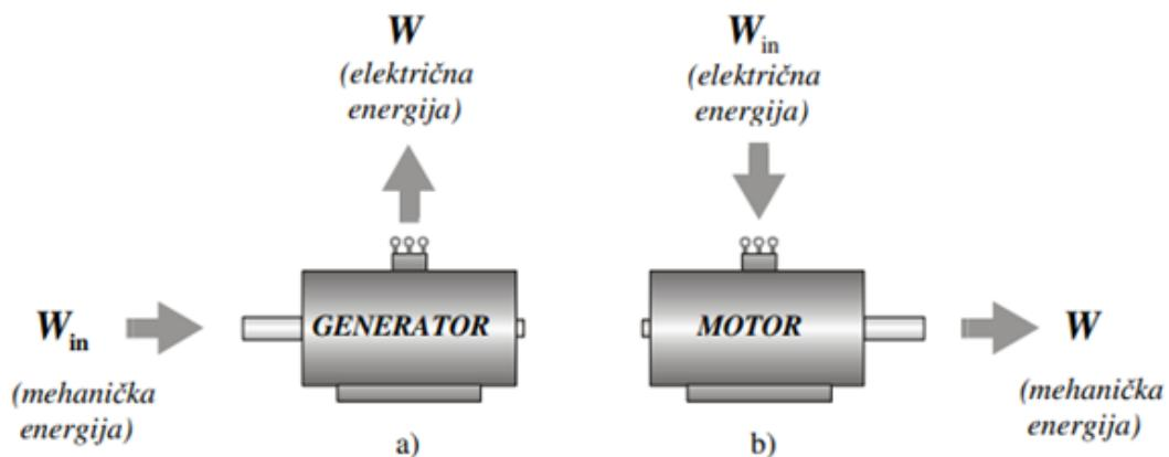
**Slika 2.1.** Pretvoba energije u električnom stroju: a) generator, b) motor. [2]
