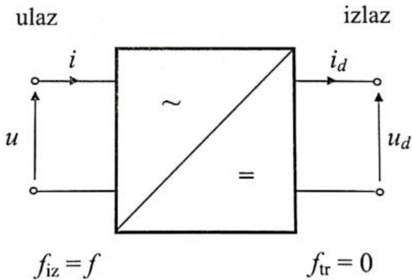
**Slika 4.9.** Simbol jednofaznog ispravljača i referentni smjerovi napona i struje na priključnicama [8]
