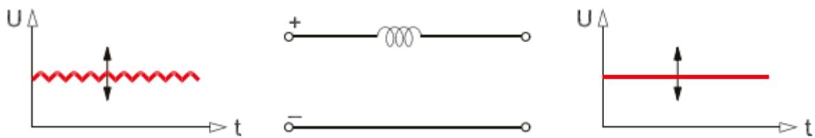
**Slika 4.14.** Strujni istosmjerni međukrug (promjenjiva amplituda izlaznog napona) [5]
