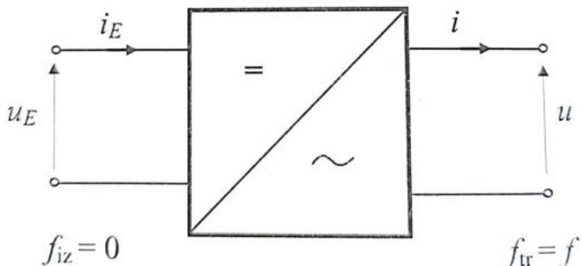
**Slika 4.19.** Simbol jednofaznog izmjenjivača i njegovi referentni smjerovi struje i napona [8]
