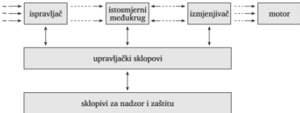
**Slika 4.7.** Blokovska shema općeg neizravnog frekvencijskog pretvarača [16]
