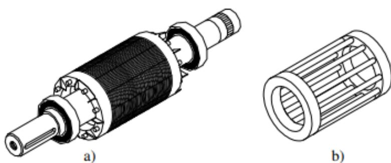
Slika 2.7. Kavezni rotor asinkronog stroja: a) rotor, b) kavez [2]
