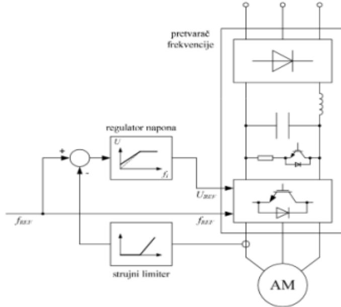
**Slika 3.6.** Skalarno upravljanje otvorenom petljom [7]
