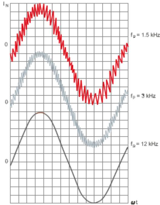
**Slika 4.20.** Ovisnost struje motora o frekvenciji [5]
