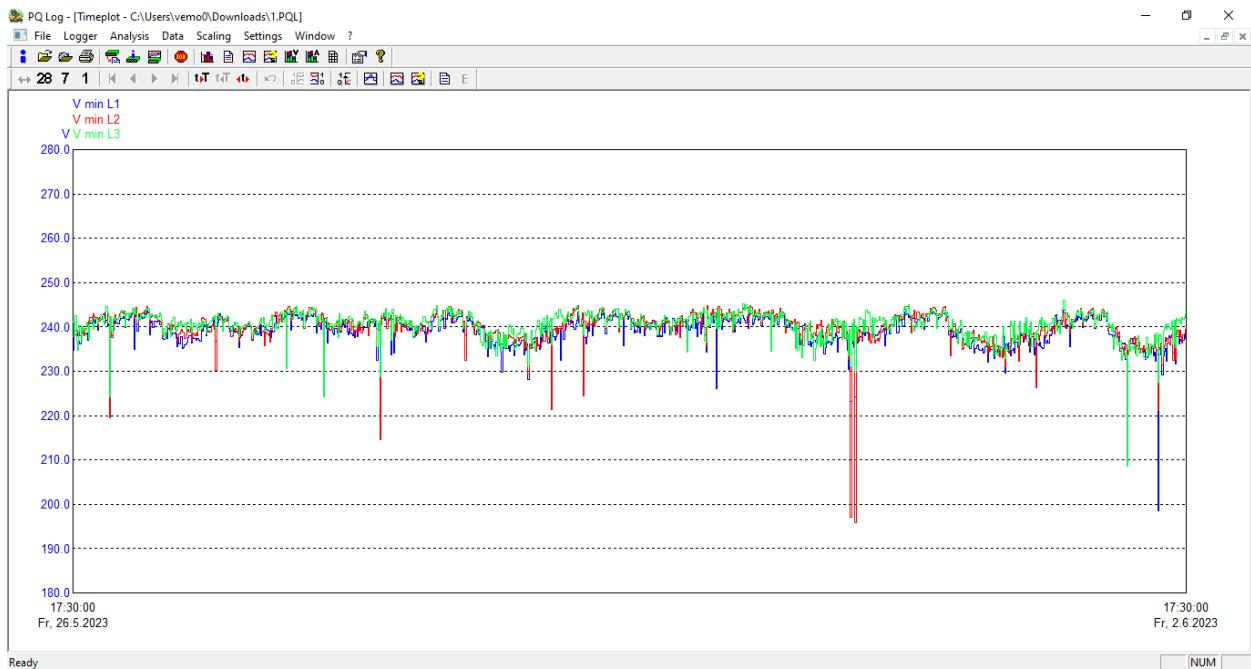
Slika 4.5. Prikazuje minimalne vrijednosti napona napajanja
