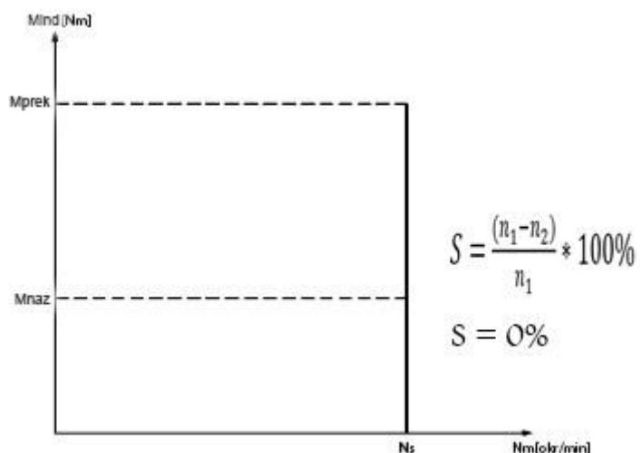
Slika 2.4: Karakteristika momenta i brzine vrtnje sinkronog motora [1]
