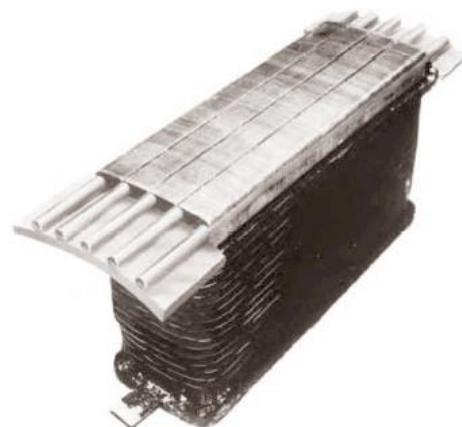
Slika 3.6: *Rotor sinkronog motora koji prikazuje kavezni namot kratko spojen na kraju pola [1]*
