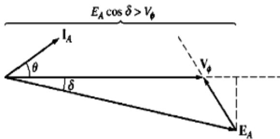
Slika 2.9b: Fazorski dijagram preuzbuđenog sinkronog motora [1]
