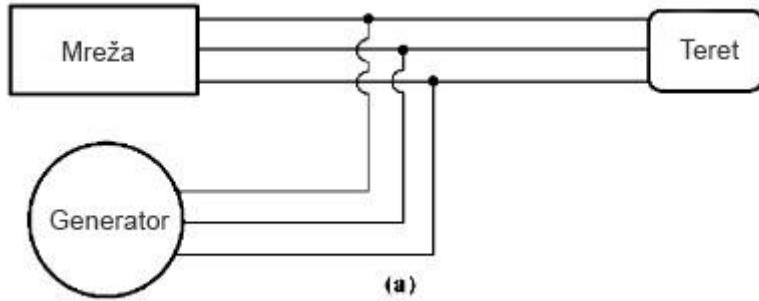
Slika 2.3: *Sinkroni generator povezan na sabirnicu sa opterećenjem [1]*
