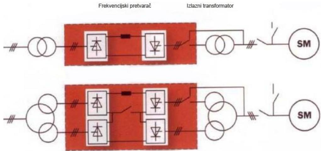
Slika 3.4: Konfiguracija za pokretanje sinkronih motora najvećih snaga (frekvencijski zalet, Megadrive-LCI) [3]
