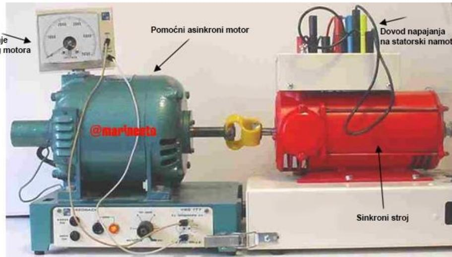
Slika 3.5: *Pokretanje sinkronog motora pomoćnim motorom [2]*
