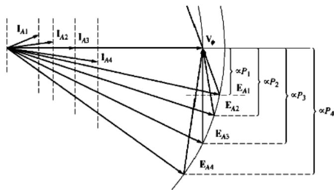
Slika 2.5b: Utjecaj povećanja opterećenja na rad sinkronog motora [1]
