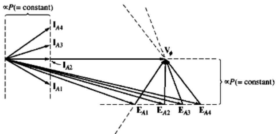
Slika 2.7b: *Utjecaj povećanja struje magnetiziranja na rad motora [1]*
