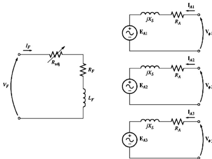
Slika 2.2a: *Ekvivalentni krug trofaznog sinkronog motora [1]*
