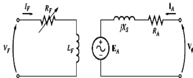
Slika 2.2b: *Ekvivalentni krug sinkronog motora po svakoj fazi [1]*
