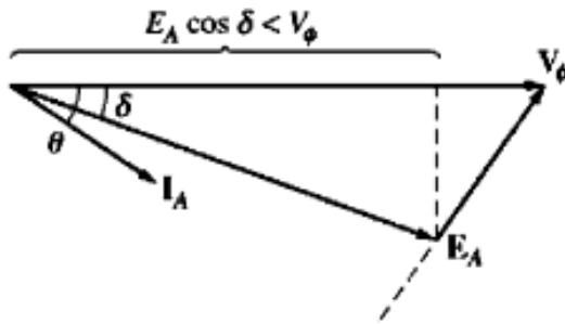
Slika 2.9a: Fazorski dijagram poduzbuđenog sinkronog motora [1]
