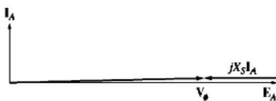
Slika 2.11: Fazorski dijagram sinkronog kondenzatora [1]
