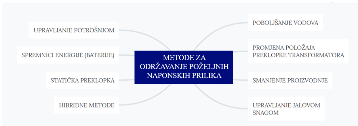
Slika 3.1. Metode za održavanje poželjnih naponskih prilika u distribucijskim mrežama s priključenim fotonaponskim elektranama [7]
