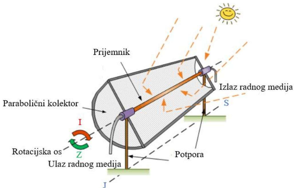
Sl. 4.2. Shema paraboličnog kolektora[9].
