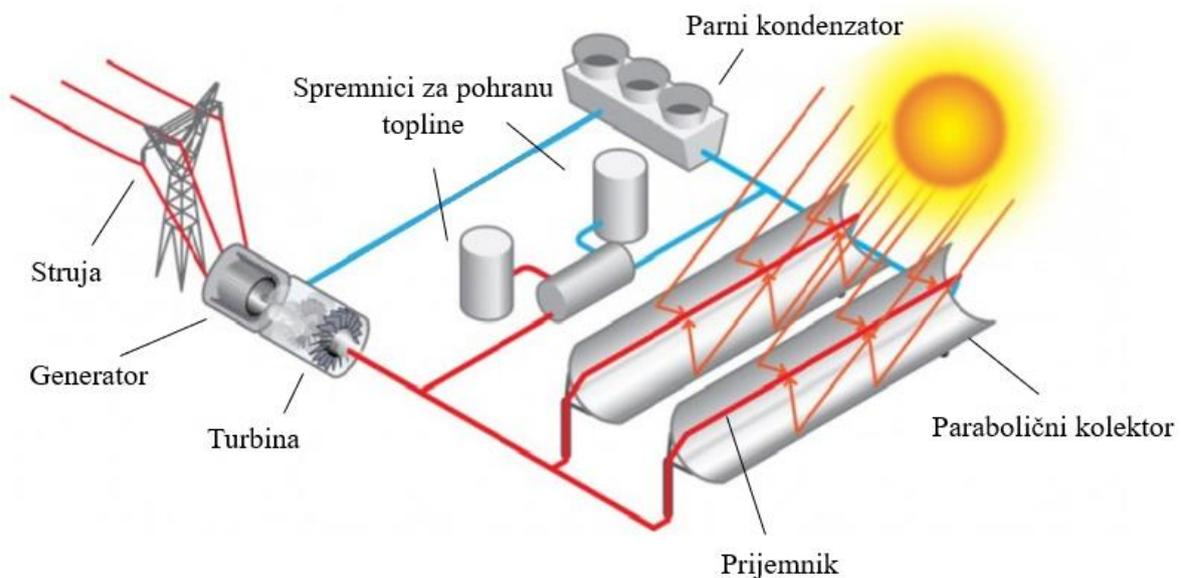
SI. 4.1. Shema solarne termoelektrane s paraboličnim kolektorima[7].
