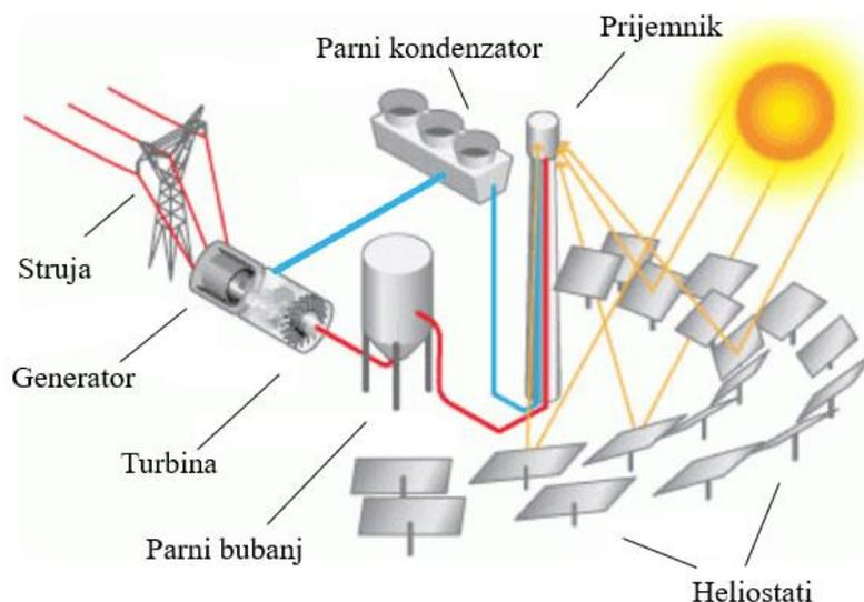
Sl. 5.1. Slika sheme solarne termoelektrane sa centralnim tornjem[15].
