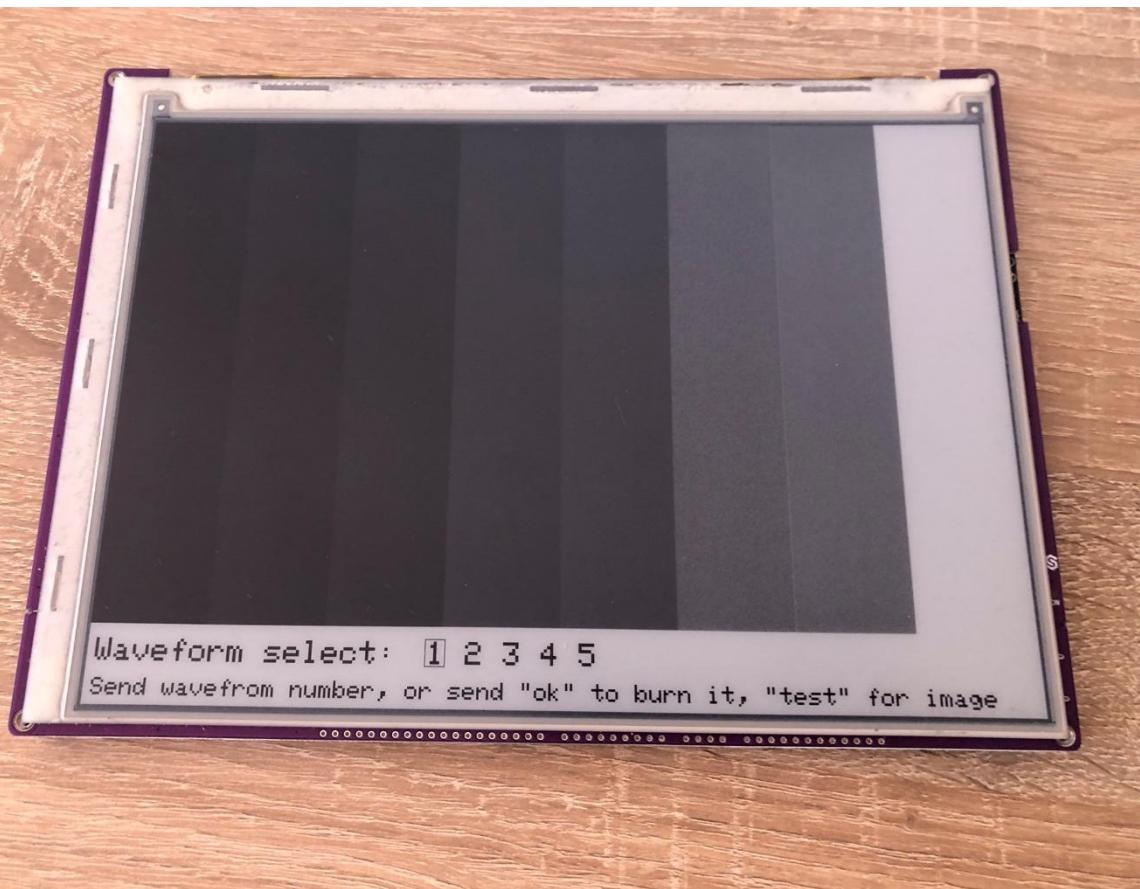
Slika 4.3. Primjer prikaza korištenjem „Inkplate\_10\_Wavefrom\_EEPROM\_Programming.ino“
