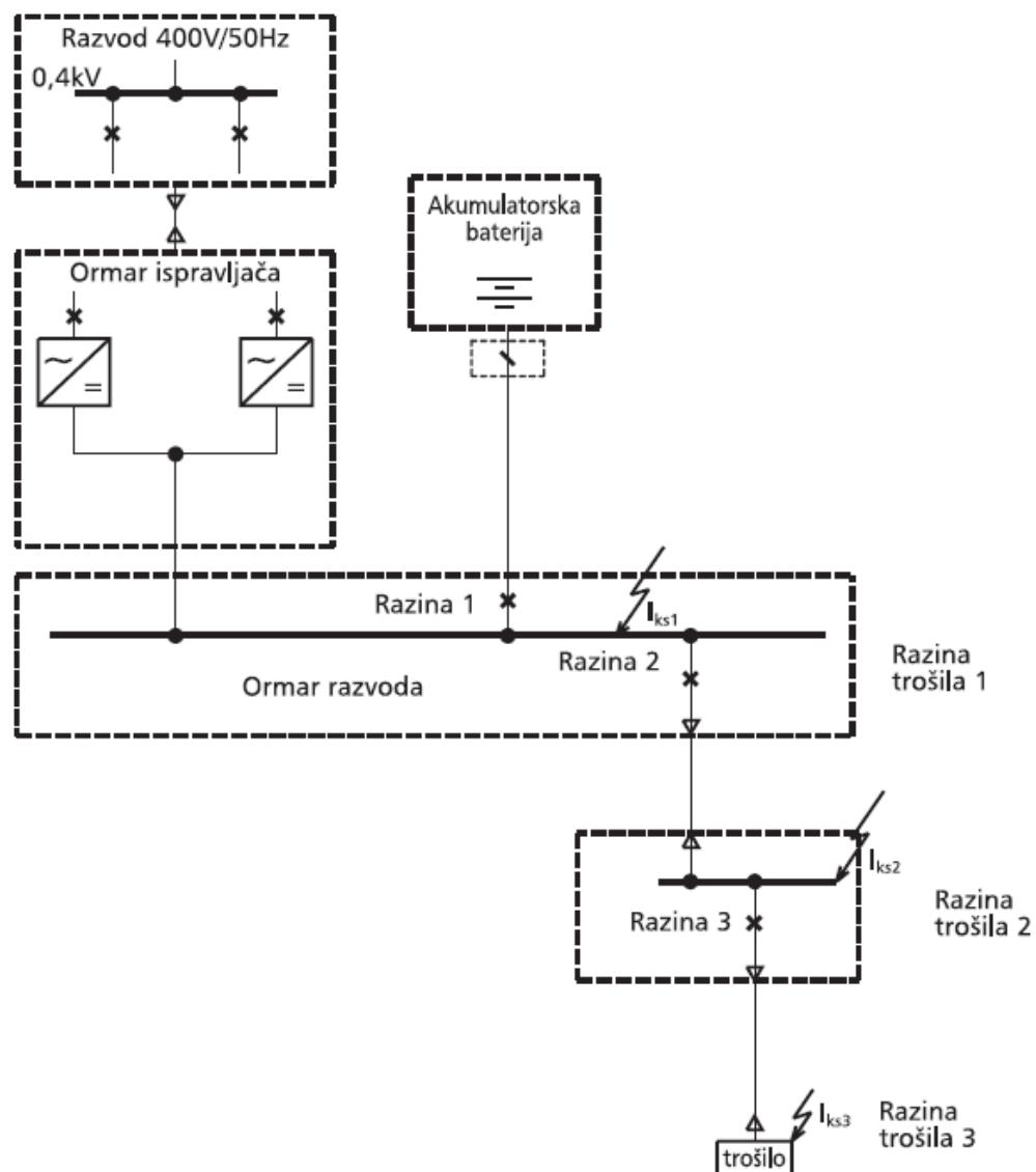
Sl. 4.1. Principijelna shema istosmjernog razvoda u tri razine s označenim glavnim dijelovima[1]
