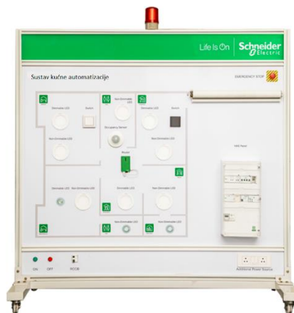
Slika 3.3. : Schneider Electric sustav kućne automatizacije - AET-P01-HAS [35]
