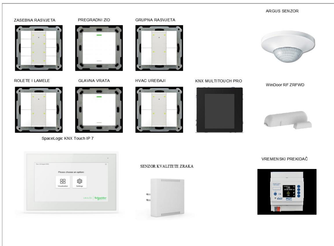
Slika 3.32. : Zamišljeni raspored i opis dijela panela s tipkalima [autorska fotografija]
