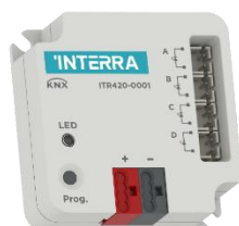
Slika 3.16. : ITR420-0001 KNX – IR pristupnik [46]
