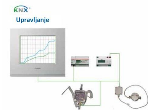
Slika 2.7. : Shematski prikaz povezivanja s KNX Metering pristupnikom [24]
