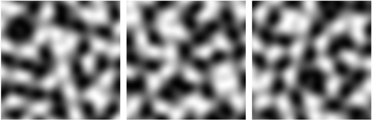
Slika 4.2. Prikaz preslikavanja dvodimenzionalnog Simplex šuma u crno-bijelu sliku. Ulazi generatora šuma su koordinate piksela na slici, a izlazna vrijednost se preslikava iz intervala [0.0, 1.0] u interval [0, 255] . Crna boja predstavlja područja blizu vrijednosti 0, dok bijela područja predstavljaju vrijednosti blizu 1. Korišteni brojevi za sjeme slika su 0, 123 i 456.
