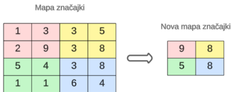
Slika 3.3. Primjer primjene MaxPool operatora, po uzoru na [15]
