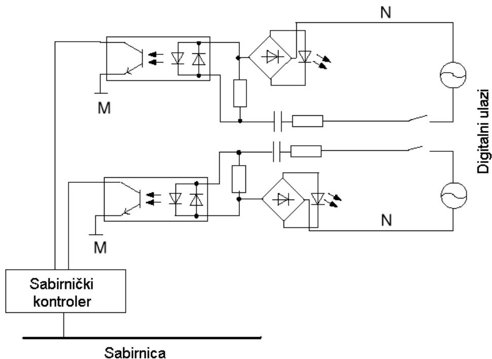
Slika 4.6 Blok shema digitalnog ulaznog modula PLC-a
