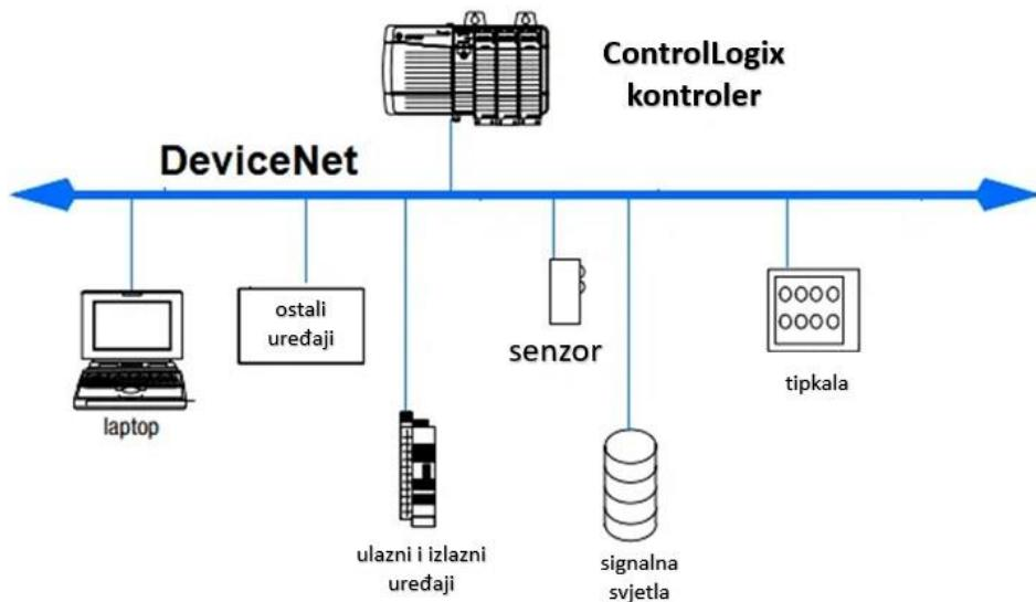
Slika 4.5. Arhitektura ControlLogix PLC uređaja
