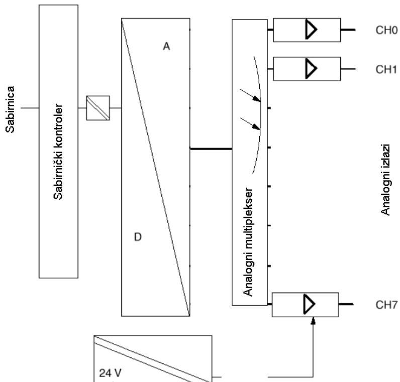
Slika 4.9. Blok shema analognih izlaznih modula PLC-a
