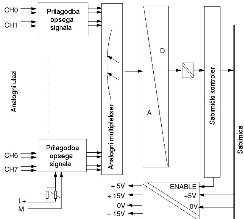
Slika 4.8. Blok shema analognog ulaznog modula PLC-a
