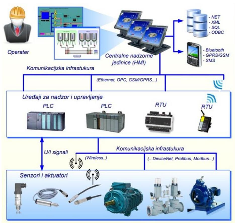
Slika 2.1. Kompletna infrastruktura sustava za nadzor i upravljanje [6]
