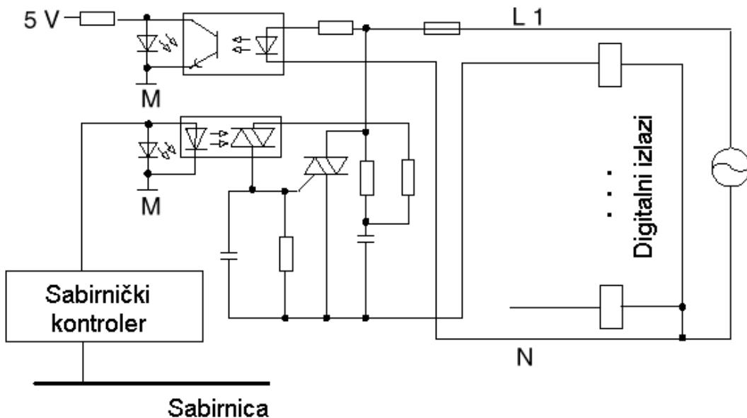
Slika 4.7. Blok shema digitalnih izlaznih modula PLC-a
