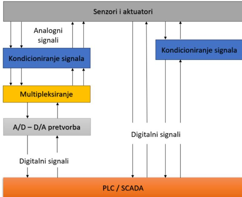
Slika 4.3. Analogni i digitalni ulazi i izlazi
