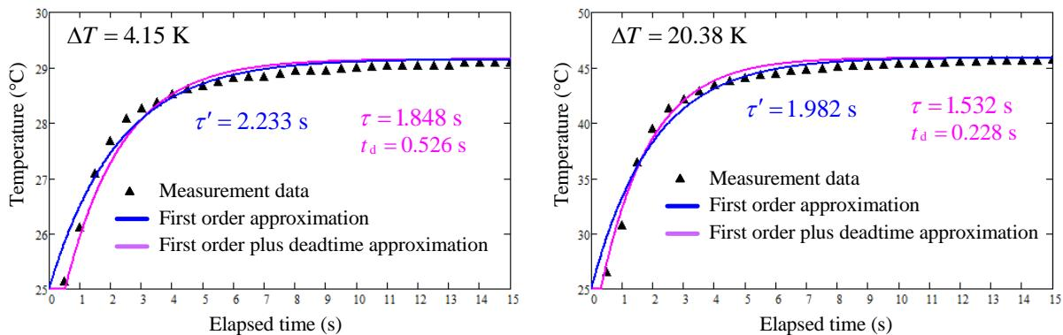
**Slika 9.4** Prikaz izmijerenog temperaturnog odziva termometra PT10000 na iznenadnu promjenu mjerene temperature i aproksimacije odziva [10]
