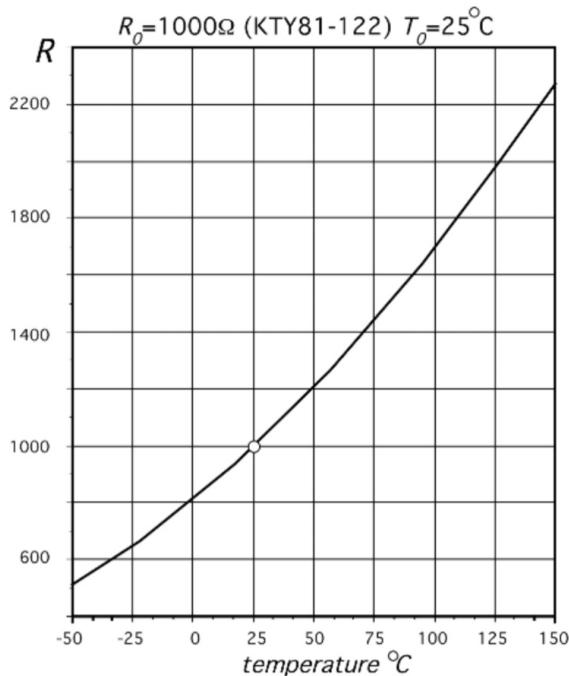
**Slika 6.5** Prikaz prijenosne funkcije KTY silikonskog senzora temperature [6]
