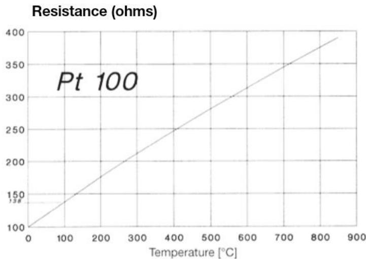
**Slika 5.2** Karakteristike senzora temperature Pt 100 [1]
