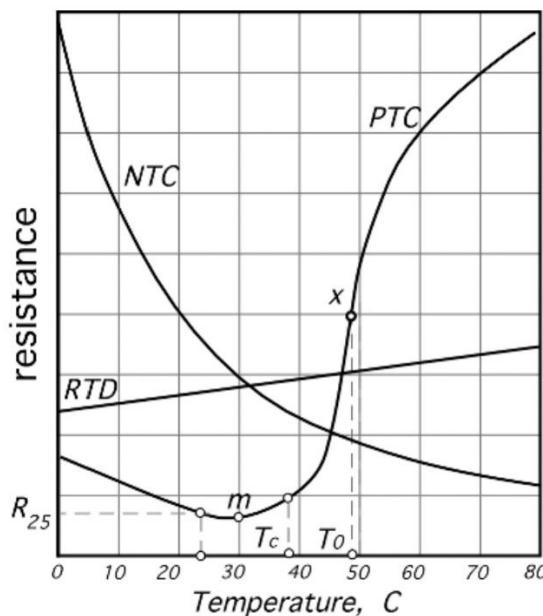
Slika 6.2 Prijenosne funkcije PTC i NTC termistora u usporedbi s RTD [6]
