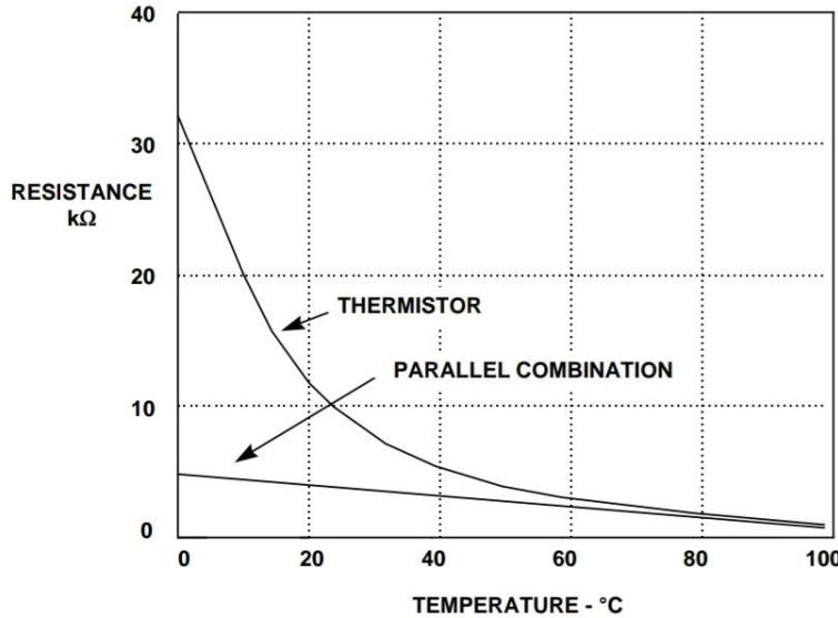
**Slika 6.6** Linearizacija NTC termistora korištenjem 5.17kΩ [12]
