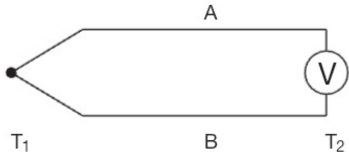
**Slika 4.1** Termoelektrični učinak
