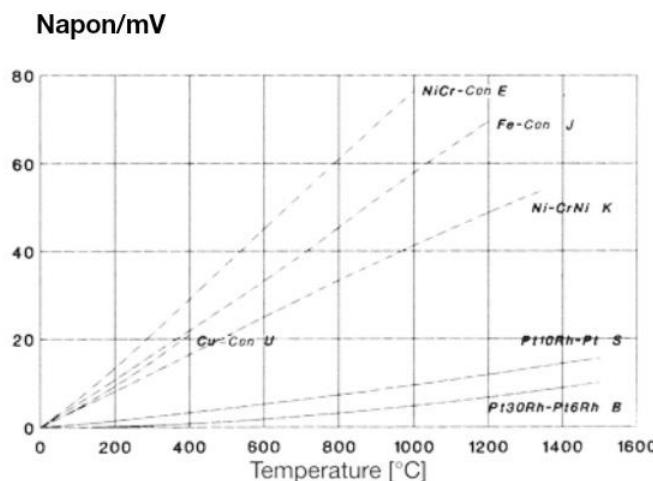
Slika 4.4 Karakteristike termoparova prema EN 60 584 [1]
