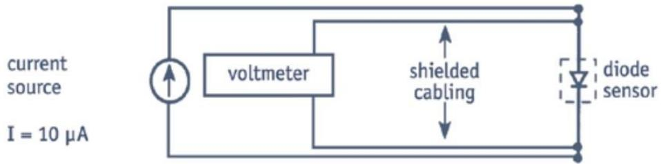
Slika 8.4 Tipična shema instrumentacije diodnog senzora [10]
