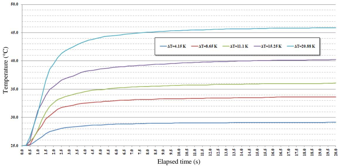
**Slika 9.3** Prikaz temperaturnog odziva, odnosno očitanja instrumenta PT10000 termometra na iznenadnu, stupnjevitu promjenu izmjere temperature [10]
