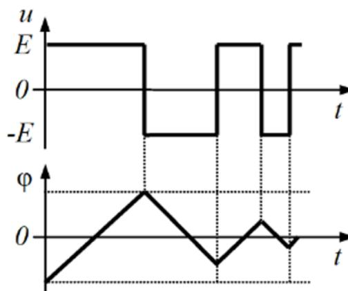
**Slika 3.8.** Prikaz smanjenja amplitude magnetskog toka pri korištenju CVVF metode [4]
