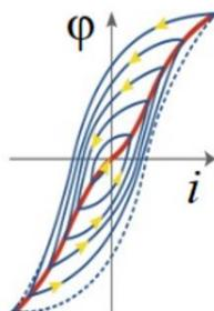
**Slika 3.6.**  $\phi$ - $i$  karakteristika tijekom postupka demagnetiziranja [4]
