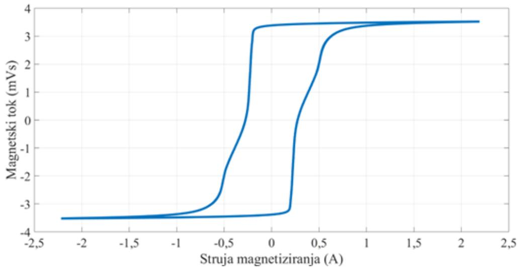
**Slika 3.3.** Karakteristika nelinearnog induktiviteta  $L$
