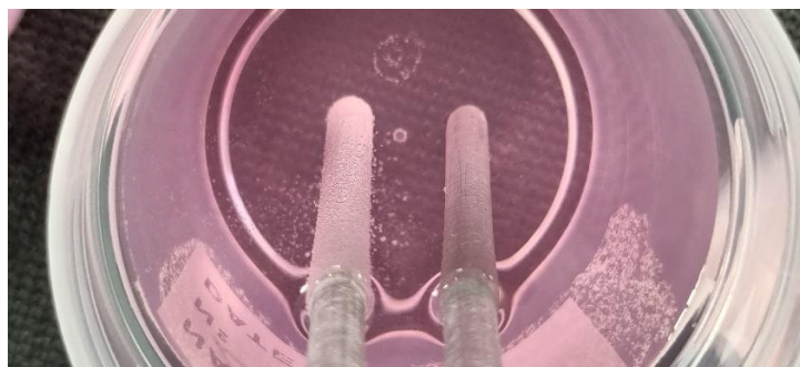
Slika 6.8. Prikaz redoks reakcija na aluminijskim elektrodama
