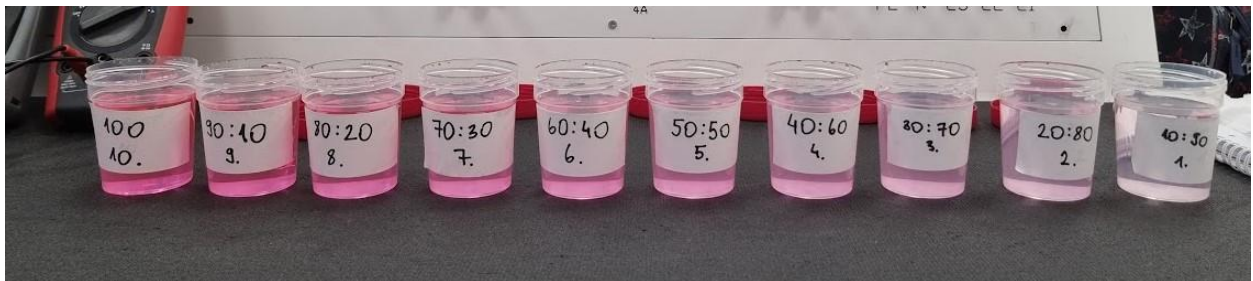
Slika 6.1. Uzorci rashladne tekućine od 100 ml sa različitim volumnim udjelima destilirane vode i antifrizu
