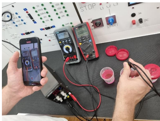
Slika 6.11. Proces mjerenja i bilježenja vrijednosti struje očitanih ampermetrom
