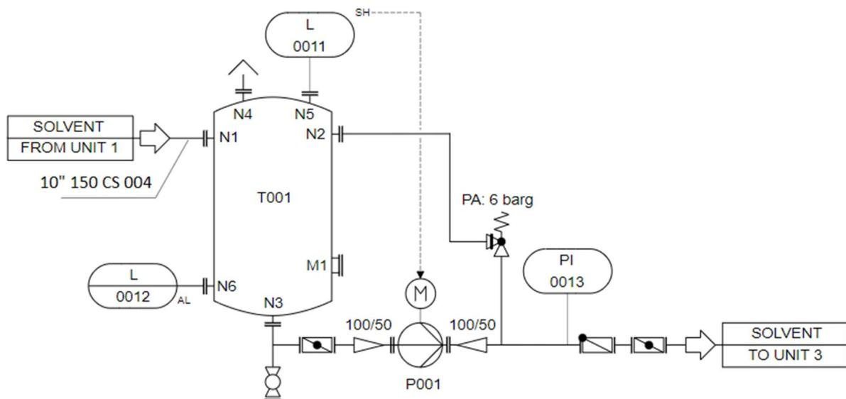
**Slika 4.2.1.1 – Procesne linije na dijagramu cjevovoda i instrumentacije**
