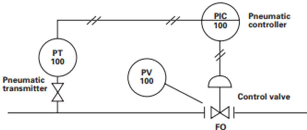
**Slika 4.3.1.** – Mjerni krug za kontrolu tlaka na ventilu [1]
