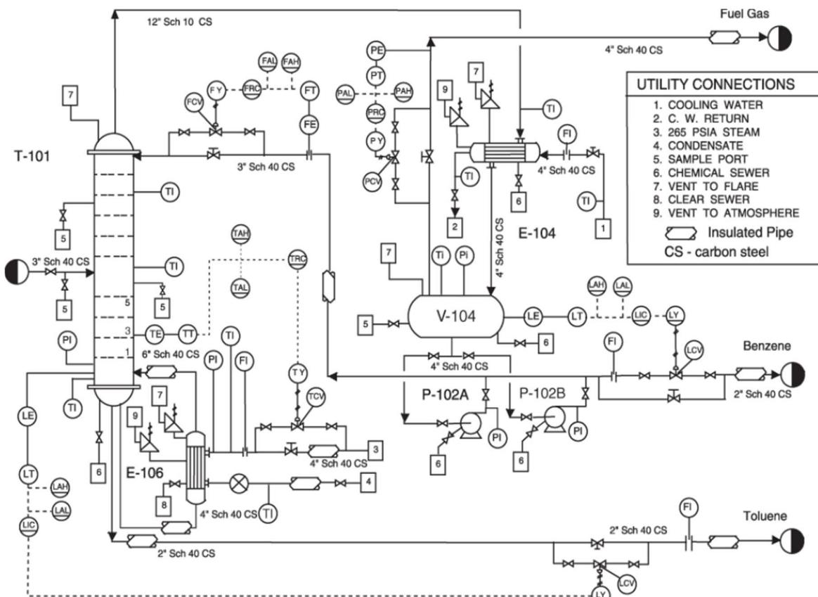
Slika 3.1 – Primjer dijagrama cjevovoda i instrumentacije
