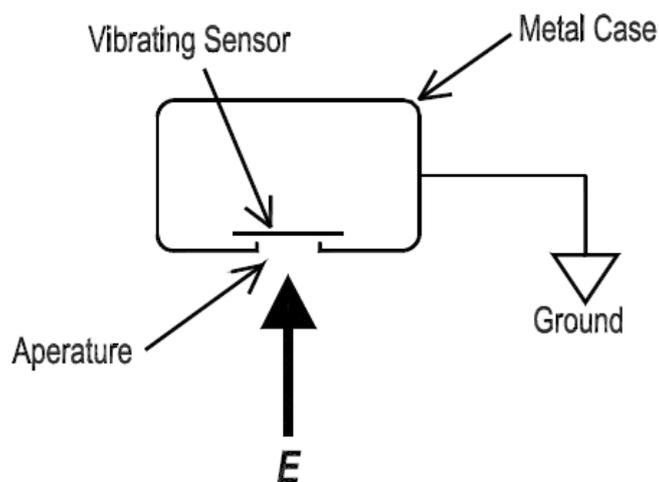
**Slika 3.6.** Pojednostavljeni prikaz sonde mjerača 1036E proizvođača Monroe Electronics [12]
