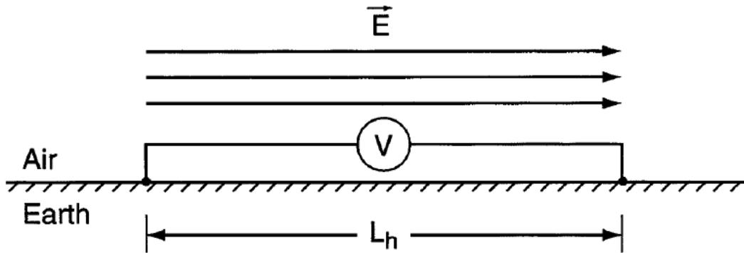
**Slika 3.8.** Pojednostavljeni prikaz vodoravne žičane antene za mjerenje električnog polja [2]
