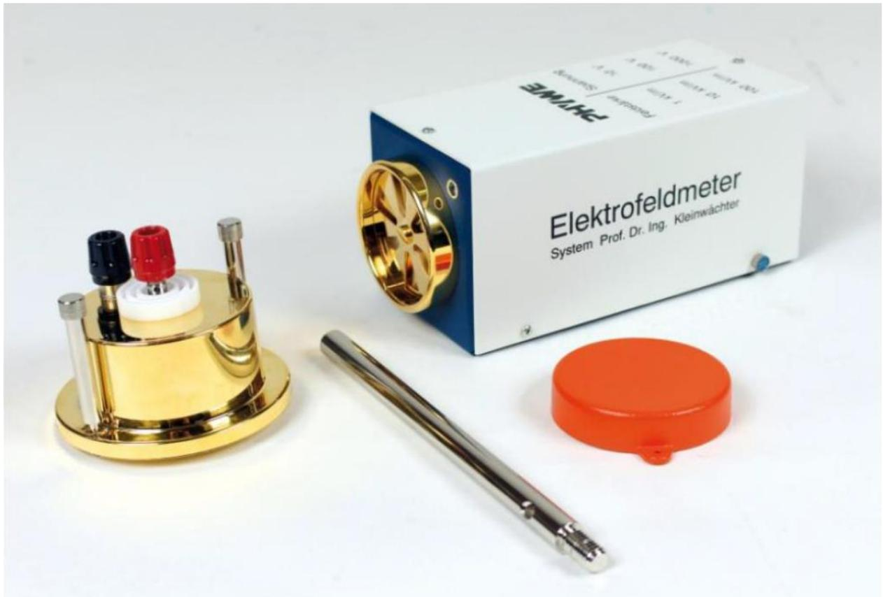
**Slika 3.2.** Mjerač električnog polja EFM 11500-20 proizvođača Phywe [10]
