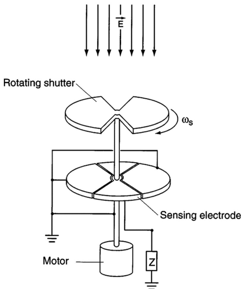
**Slika 3.1.** Pojednostavljeni prikaz mjerača polja sa rotirajućim „zatvaračem“ [2]
