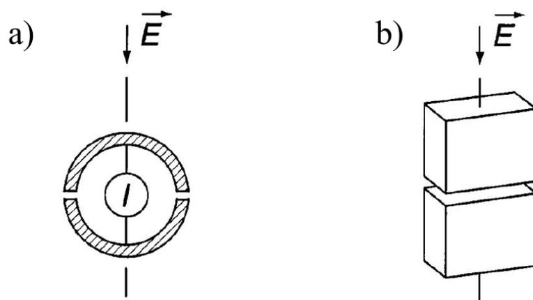
**Slika 3.9.** Izvedbe „free-body“ mjerača električnog polja [2]
