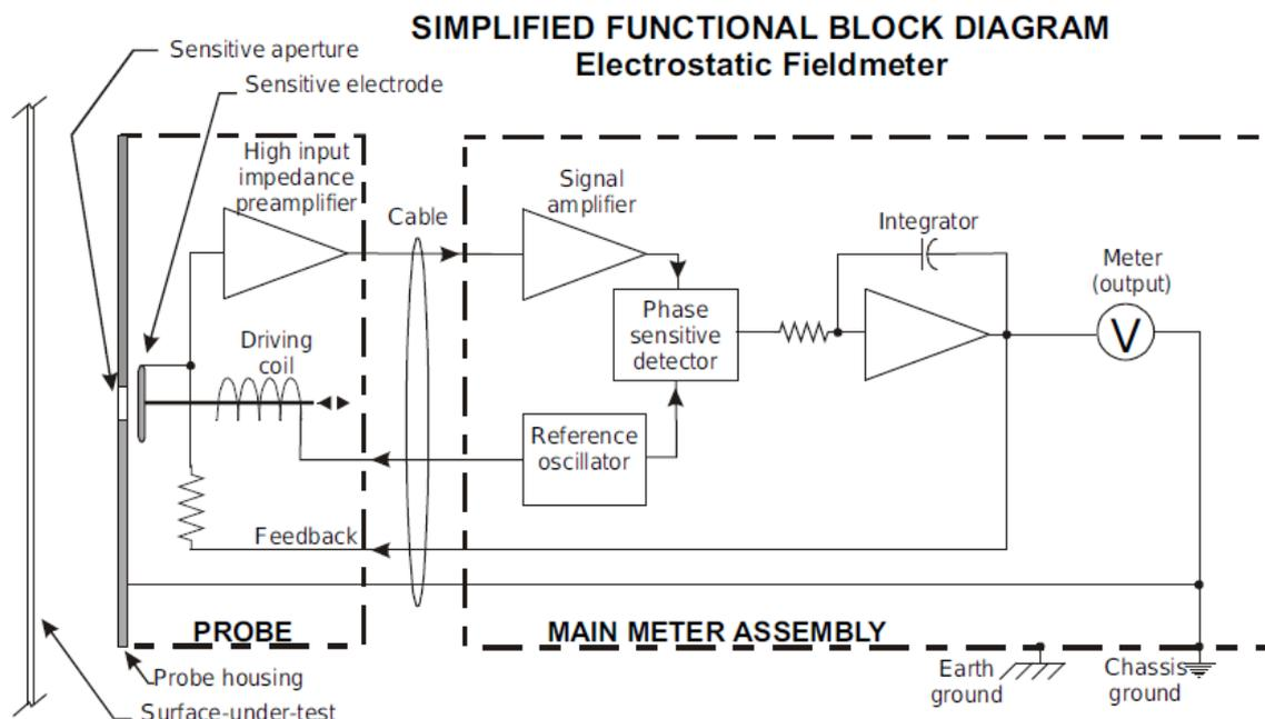
**Slika 3.7.** Shema 1036E mjerača električnog polja sa vibrirajućom pločom [12]
