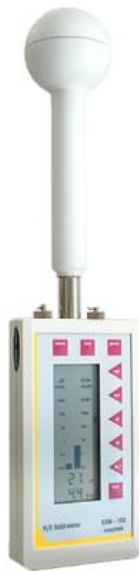
Slika 4.1. Mjerač električnih i magnetskih polja Maschek ESM-100 [16]
