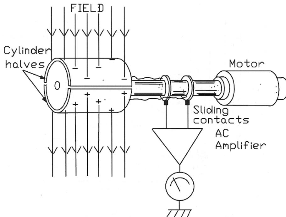
**Slika 3.4.** Pojednostavljeni prikaz cilindričnog tipa mjerača elektrostatskog polja [11]
