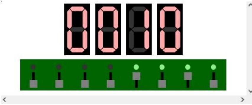
*Slika 4.4: Primjer izvršavanja programa *Binary to Decimal*." Preko prekidača mu je unesen binarni broj (0000)1010 (prekidač gore, naravno, označava jedinicu, a prekidač dolje nulu), a on ga je pretvorio u dekadski broj 10 te je to ispisao na 7-segmentnom displeju. Također ga je pretvorio u Grayev kod (0000)1111, te je to ispisao pomoću LED-ica (primjetite da su zadnje 4 LED-ice upaljene, dok su prve četiri ugašene).*
