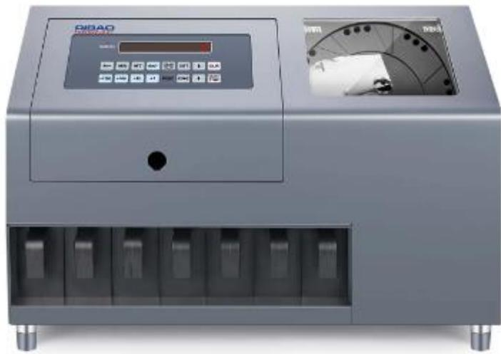
Slika 2.1 Uređaj za sortiranje kovanica s rotirajućim diskom, [4].
