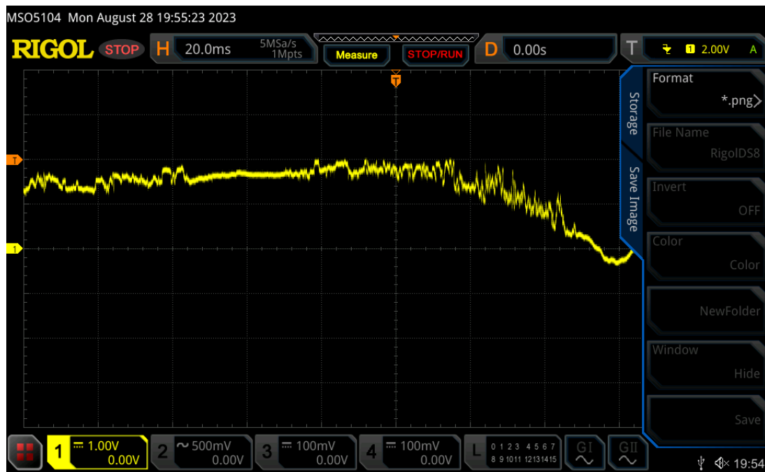
Slika 3.5. Prikaz snimljenog šuma sa potenciometra joysticka prilikom upravljanja gljivom joysticka
