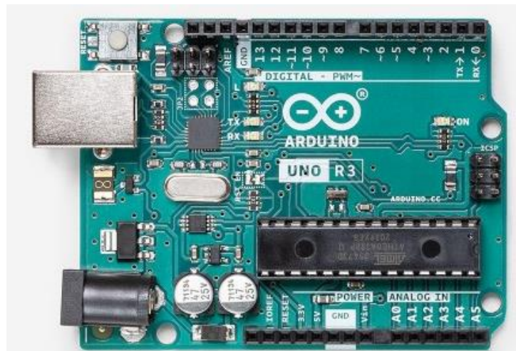
Slika 2.6. Primjer mikroupravljačke pločice[8]
