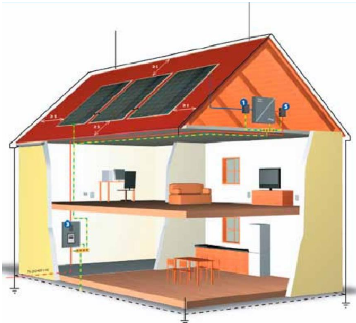
Slika 40. Fotonaponski sustav i gromobranska instalacija objekta [2]
