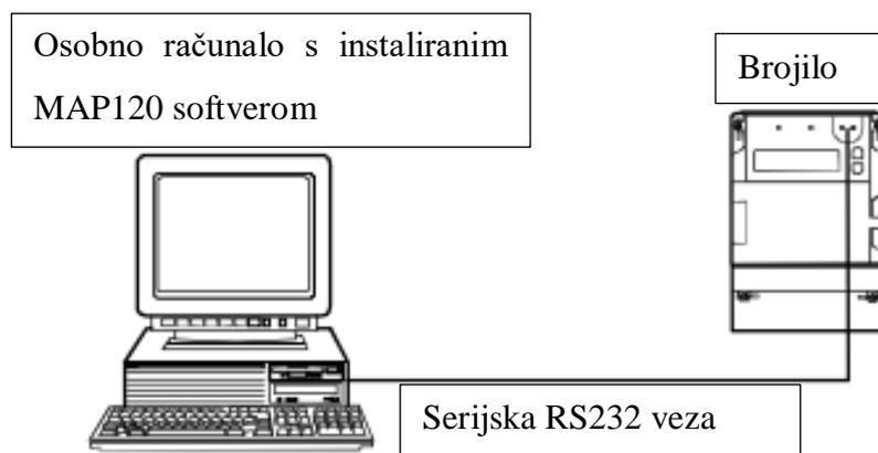
Slika 4.1. Mjerni instrument spojen na računalo [14]
