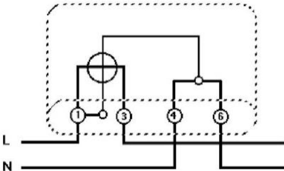
Slika 2.4. Priključak jednofaznog jednotarifnog elektromehaničkog brojila [7]
