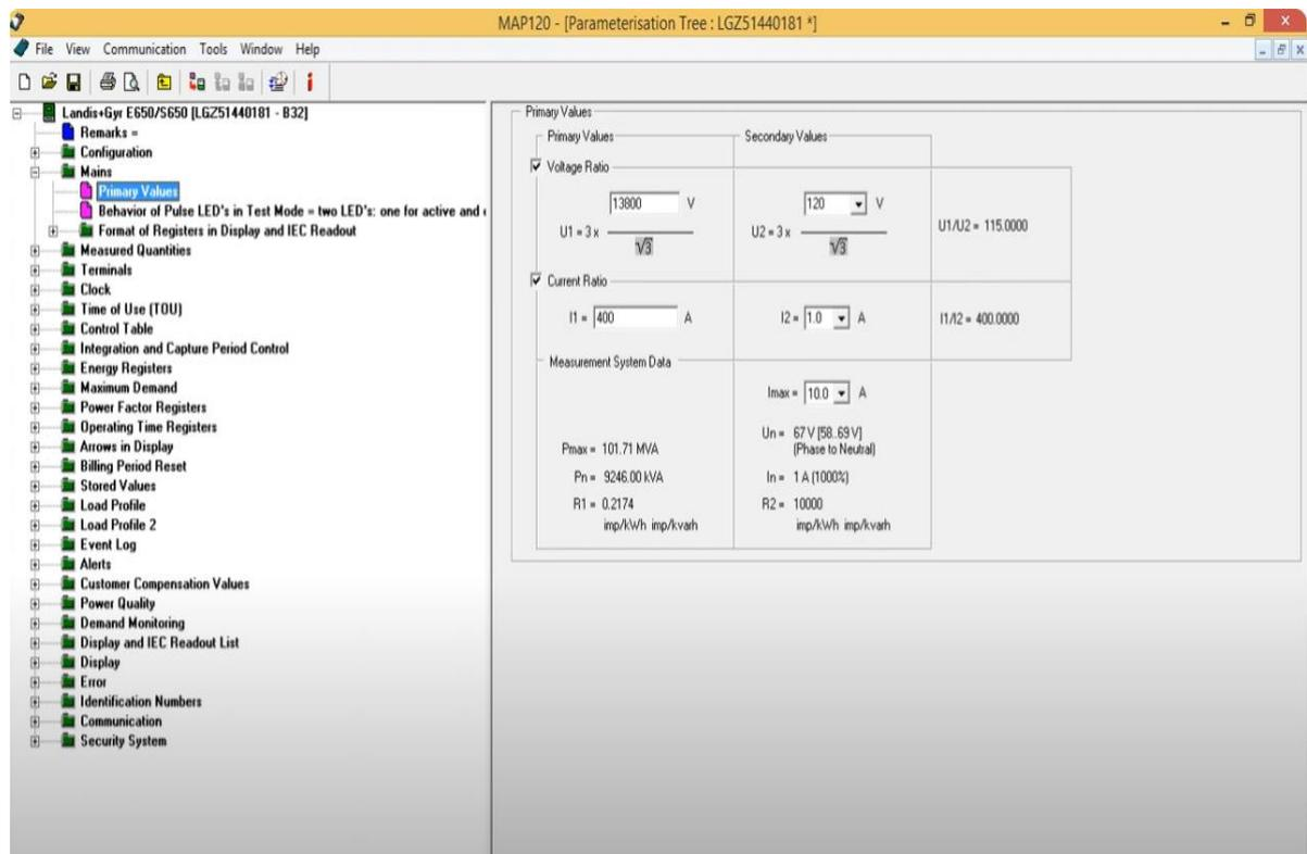
Slika 4.15. Izbornik primarnih i sekundarnih vrijednosti [17]
