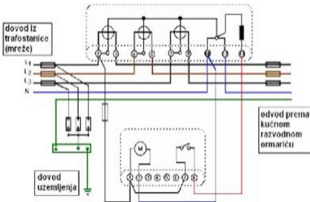
Slika 2.5. Priključak trofaznog dvotarifnog elektromehaničkog brojila [8]
