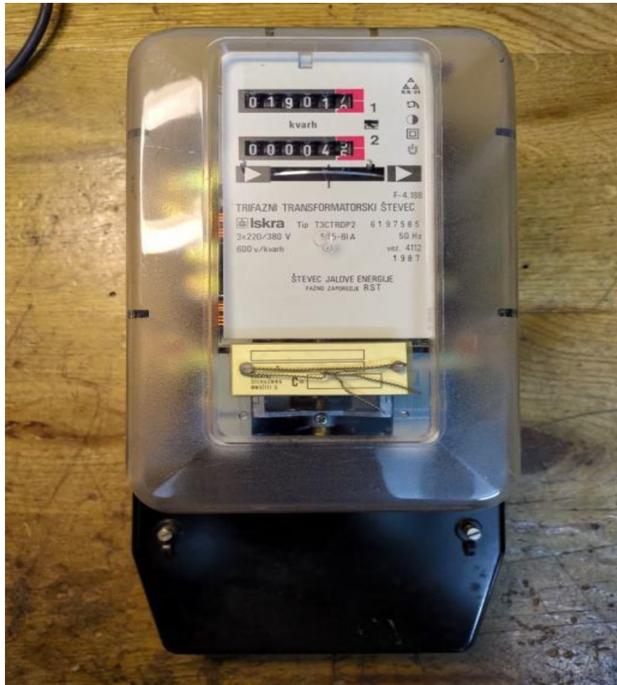
Slika 2.2. Elektromehaničko brojilo s dvije tarife
