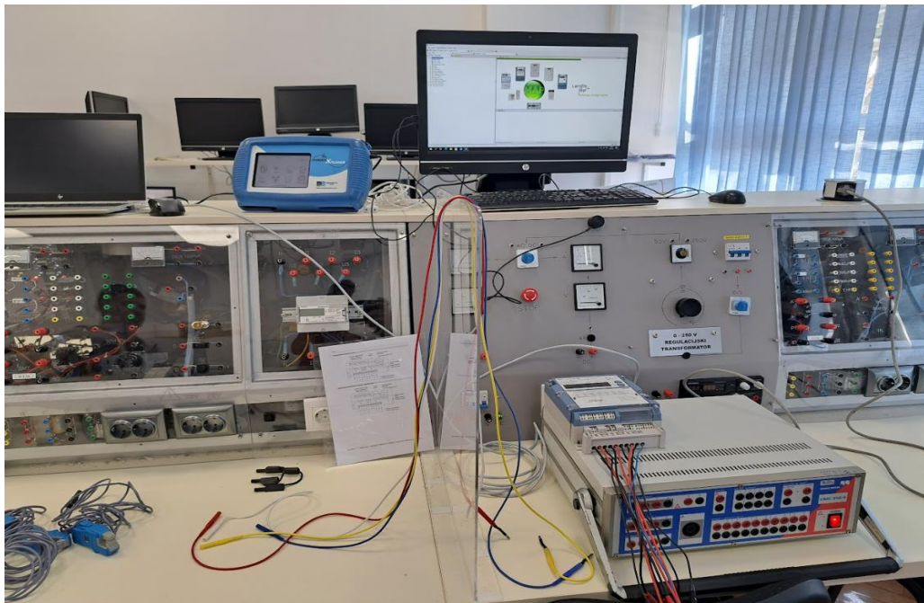
Slika 4.2. Fotografija radnog mjesta gdje je brojilo povezano s osobnim računalom
