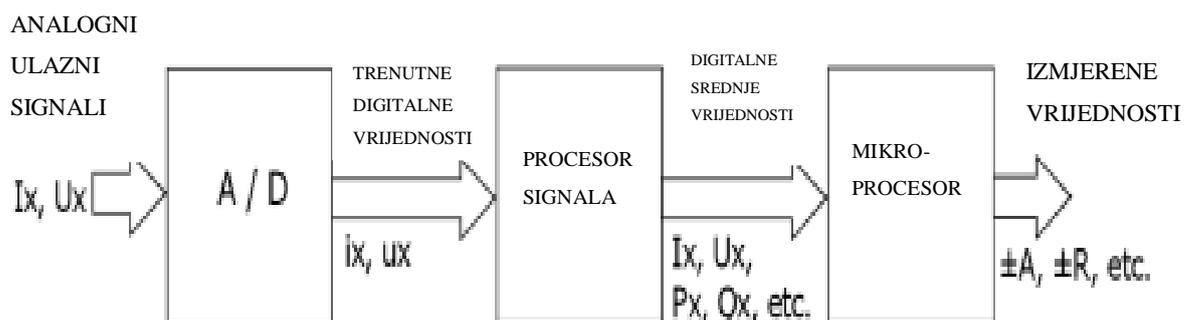
Slika 3.7. Blok shema načela mjerenja [12]
