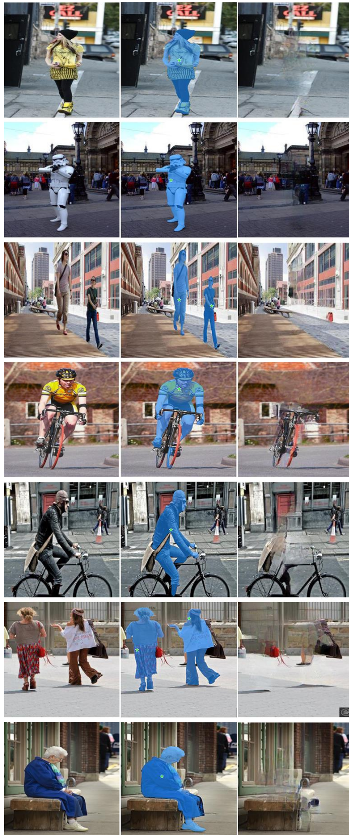
Sl. 5.3. Primjer popunjavanja slika uz korištenje SAM modela. Stupac a) original slika, b) SAM segmentacija, c) konačna slika.
