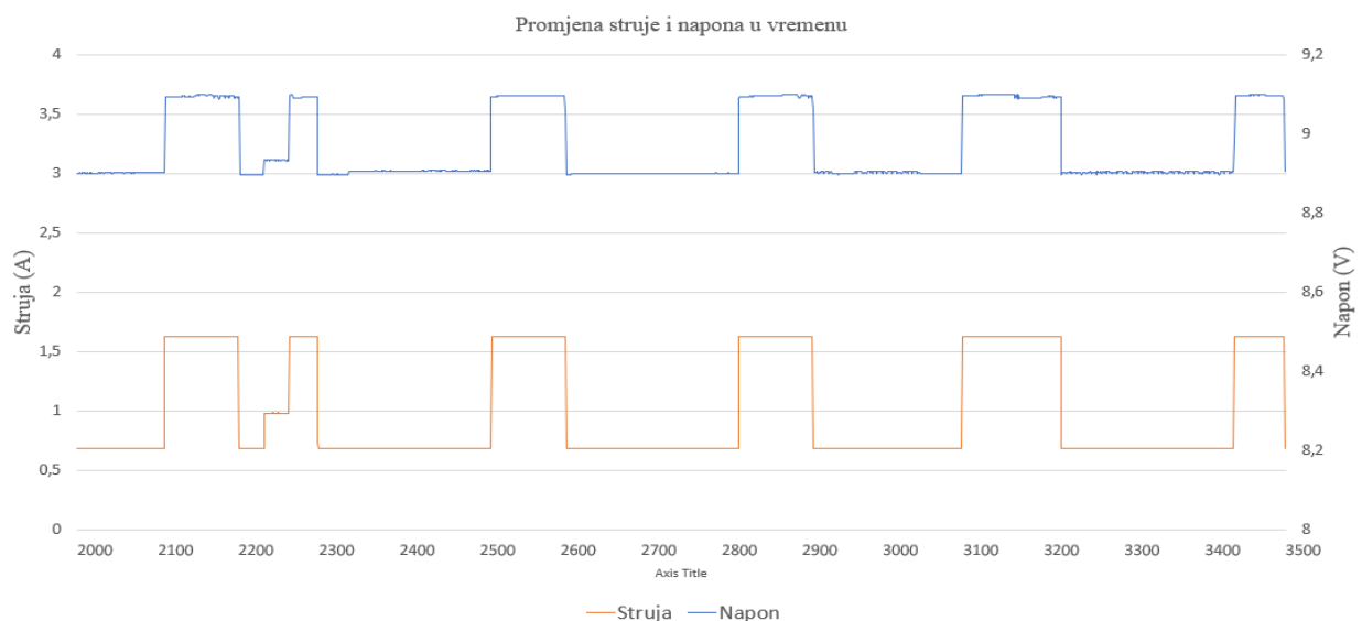
Slika 5.9. Grafički prikaz struje i napona tijekom prve faze brzog punjenja Galaxy S21
