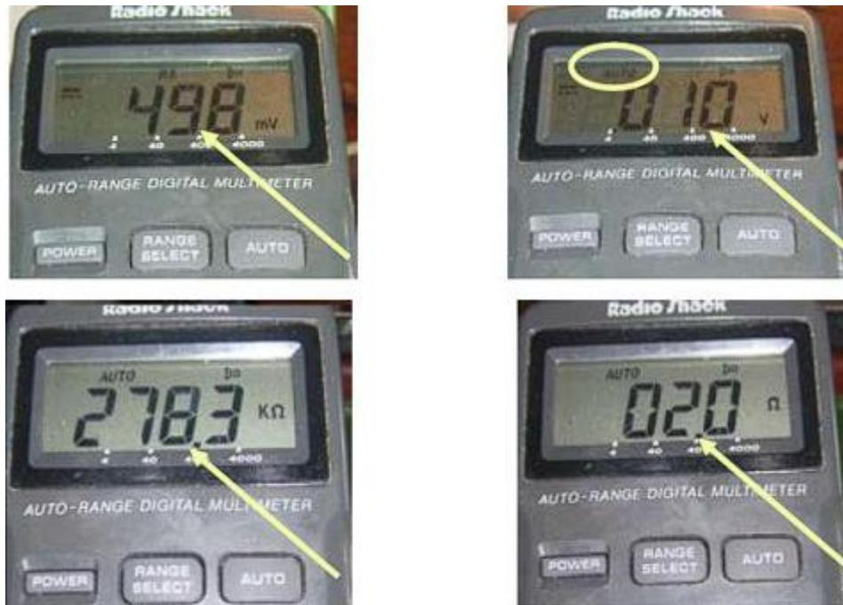
Slika 3.3 Razlučivost digitalnog instrumenta [4]
