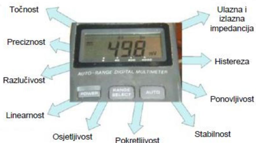
Slika 3.1 Prikaz karakteristika mjernog instrumenta [2]
