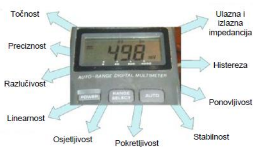
Slika 3.1 Prikaz karakteristika mjernog instrumenta [2]
