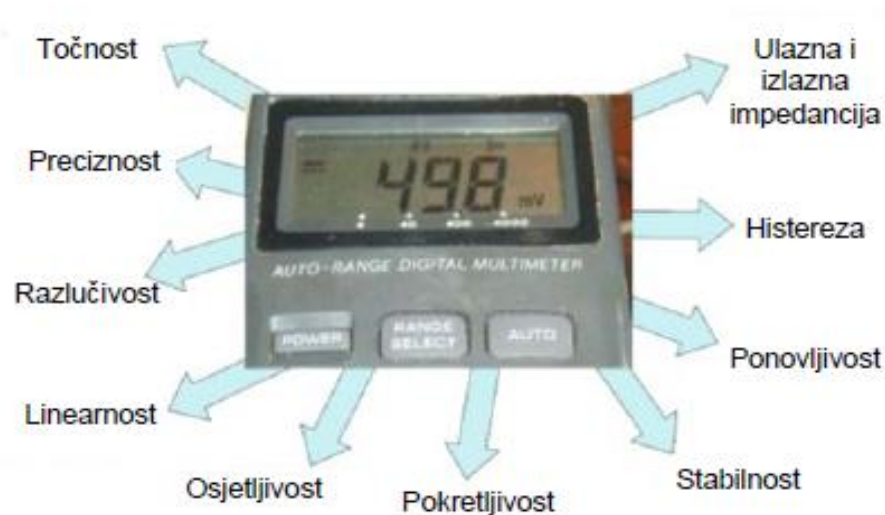
Slika 3.1 Prikaz karakteristika mjernog instrumenta [2]
