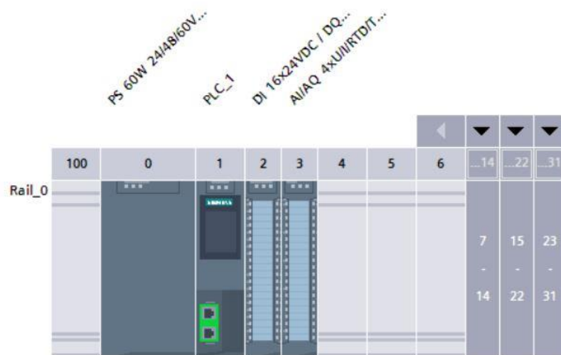
Sl. 3.3. prikaz odabrane hardverske konfiguracije PLC-a
