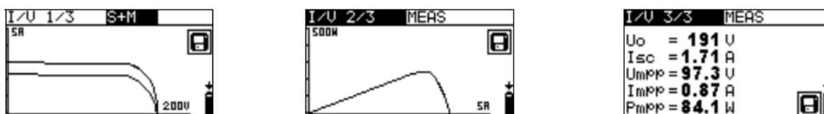
Sl. 6.4. Primjer mjerenja I - U karakteristike [28]
