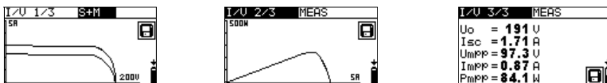
Sl. 6.4. Primjer mjerenja I - U karakteristike [28]
