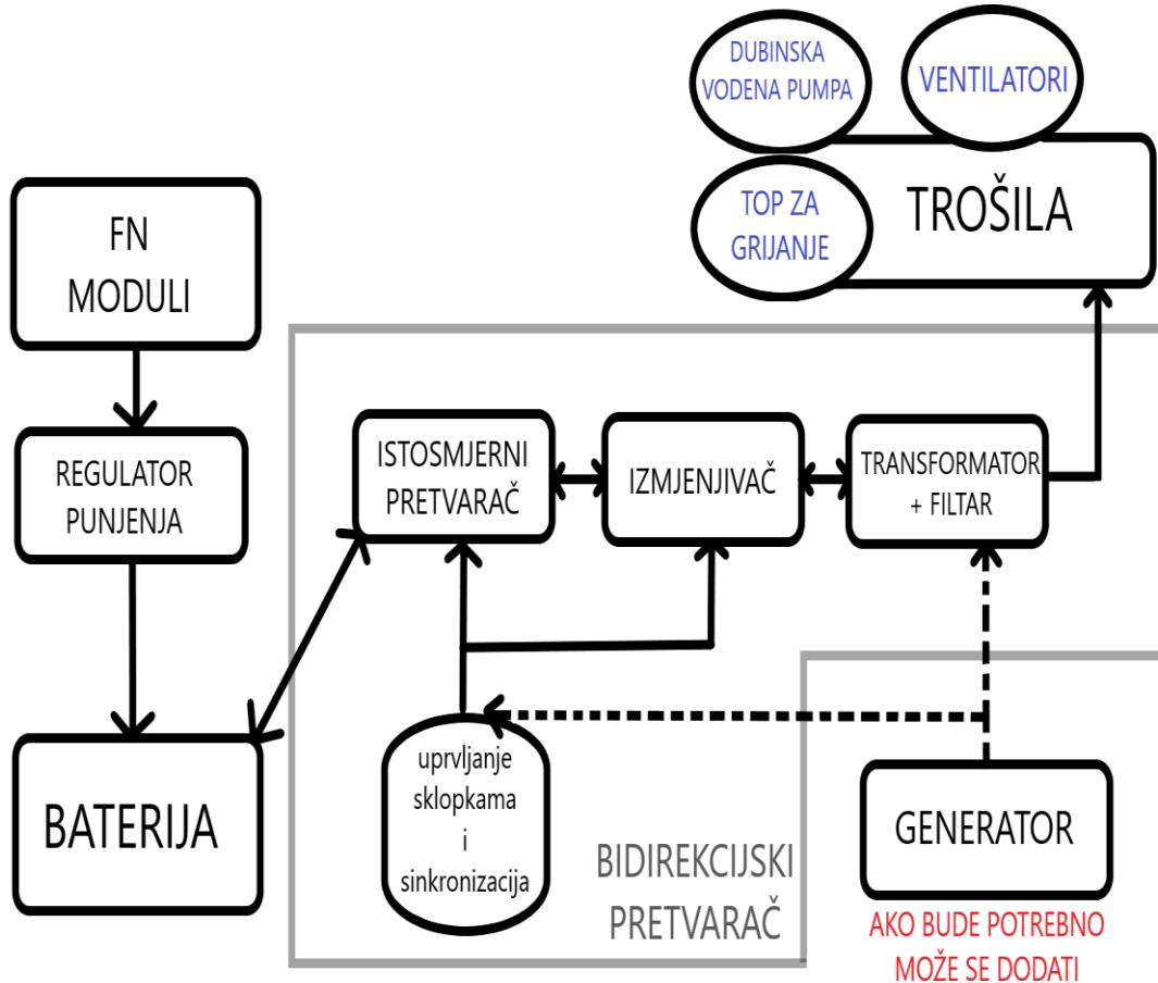
Slika 4.1. Shema autonomnog fotonaponskog sustava s trošilima [15]
