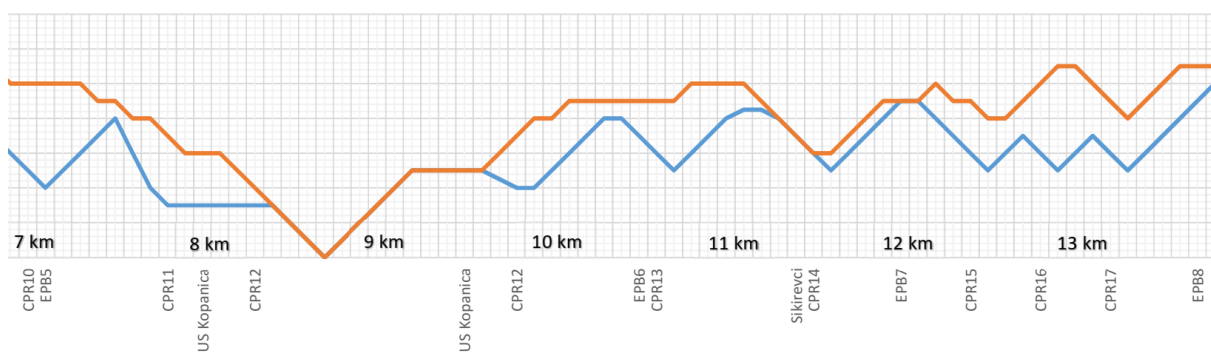
Slika 6.9. – Dijagram brzine vlaka od km 7 do km 14 na sekciji pruge: Vrpolje – Državna granica HR
