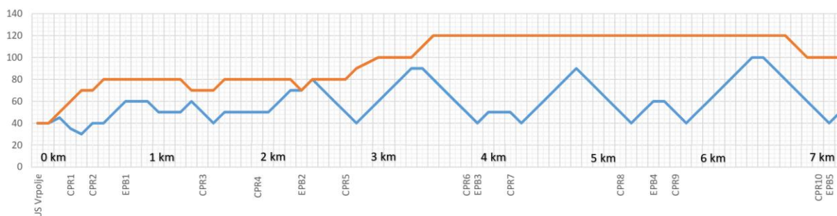
Slika 6.8. – Dijagram brzine vlaka od km 0 do km 7 na sekciji pruge: Vrpolje – Državna granica HR
