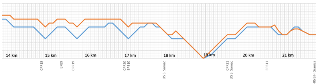
Slika 6.10. – Dijagram brzine vlaka od km 14 do km 22 na sekciji pruge: Vrpolje – Državna granica HR
