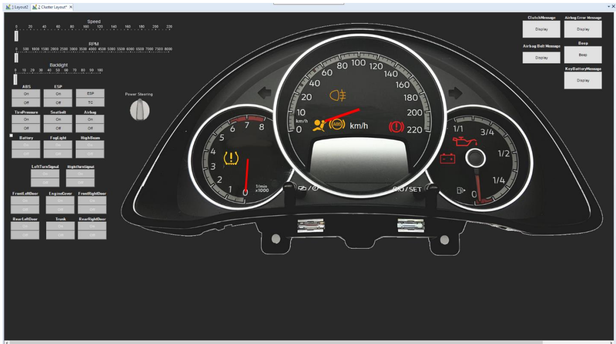
Slika 5.21. Grafičko sučelje ControlDesk aplikacije za upravljanje kontrolnom pločom.
