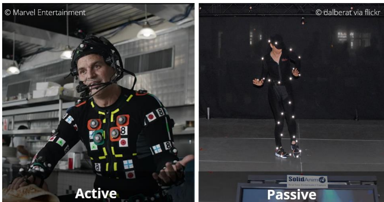
Slika 2.3. Aktivni i pasivni optički sustavi snimanja pokreta[11].
