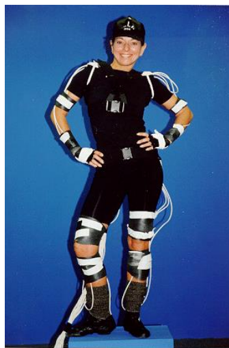
Slika 2.2. Oprema za magnetski sustav snimanja pokreta[9].
