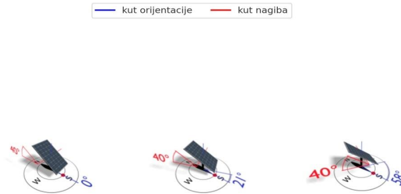
Slika 6.10. Jednoosni FN sustav s rotirajućom vertikalnom os
