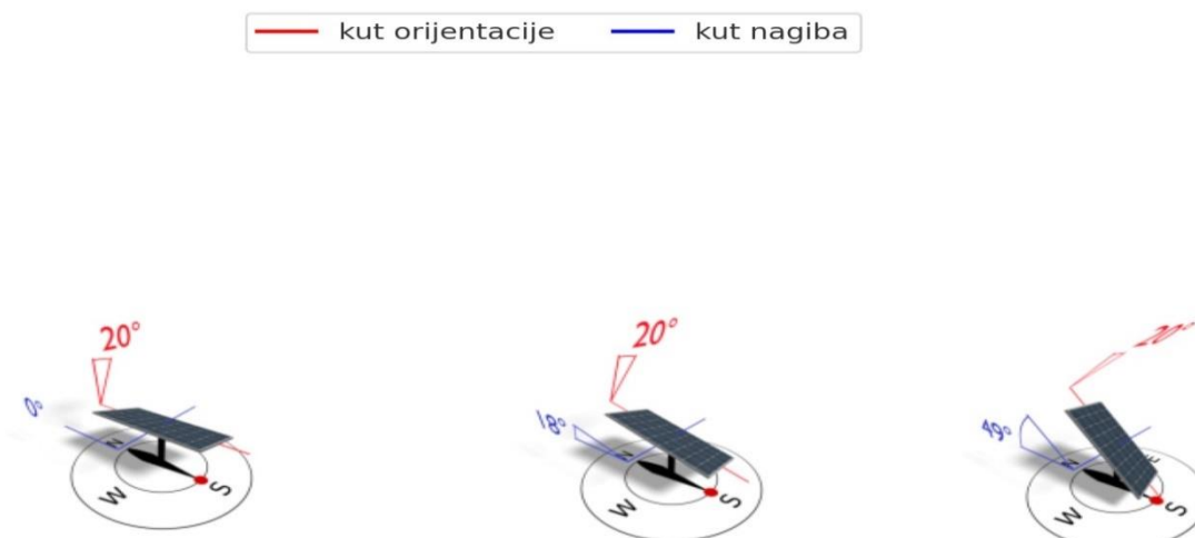
Slika 6.7. Jednoosni FN sustav s os istok-zapad
