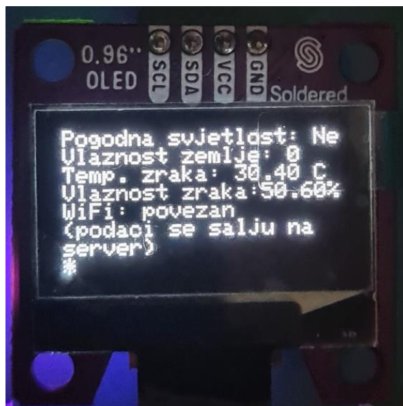
Sl. 3.24. Prikaz podataka očitanih na sensorima koji se šalju na Arduino poslužitelj u oblaku
