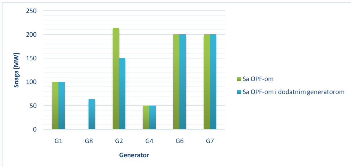
Slika 5.38: Izlazne snage generatora sa dodatnim generatorom na sabirnici 3
