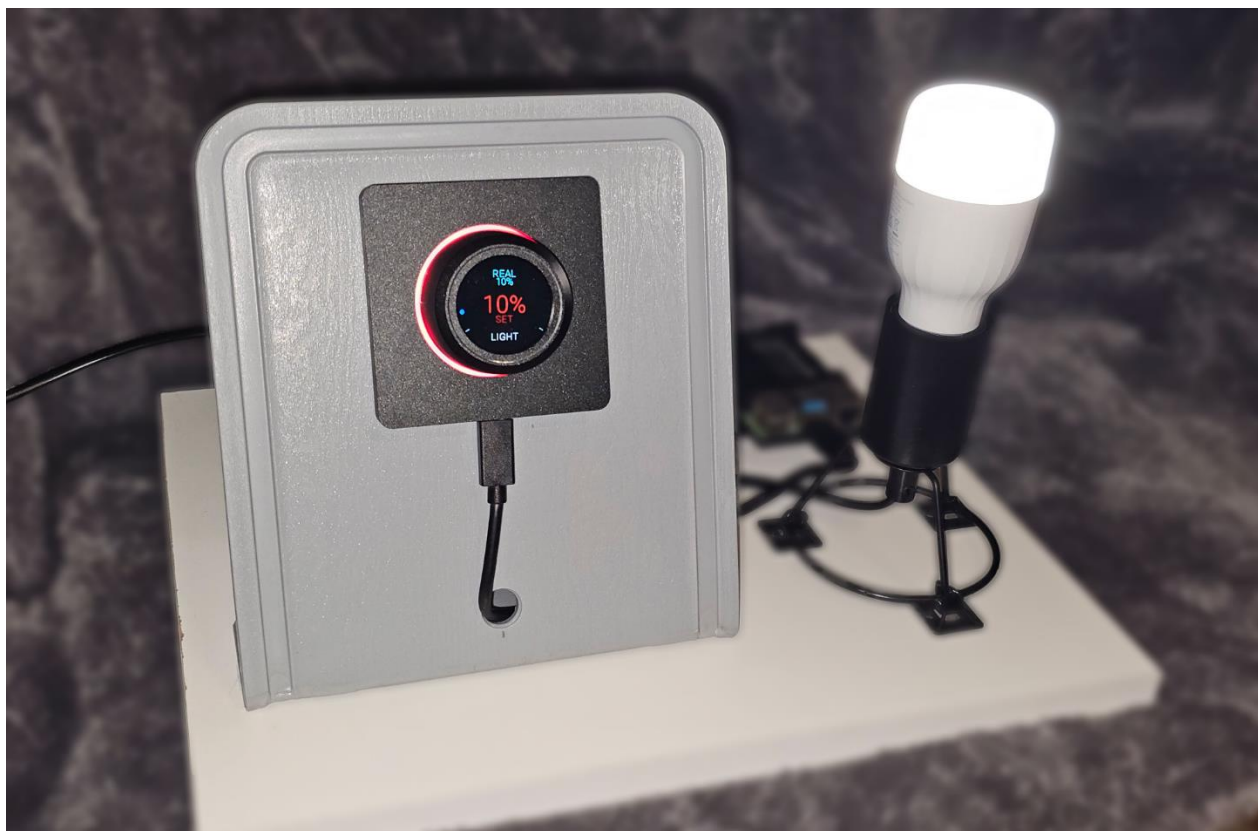
Slika 3.12. Primjer regulacije intenziteta rasvjete
