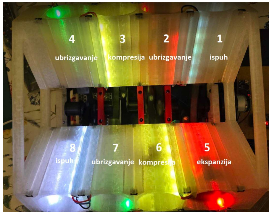
Slika 4.8. Prikaz zajedničkog rada klipova u cilindrima
