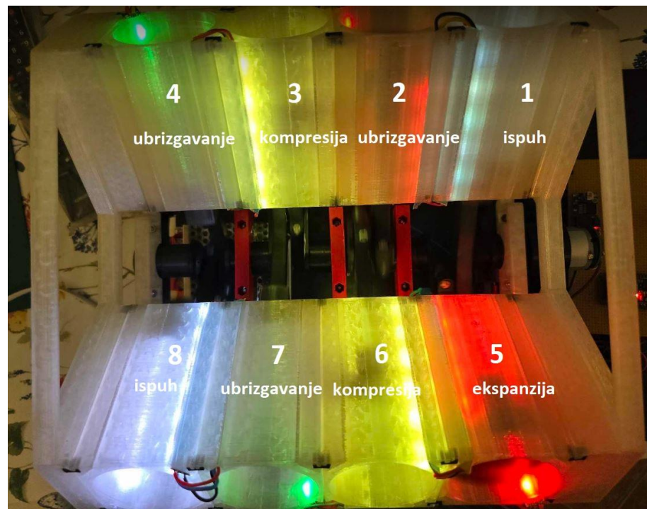
Slika 4.8. Prikaz zajedničkog rada klipova u cilindrima
