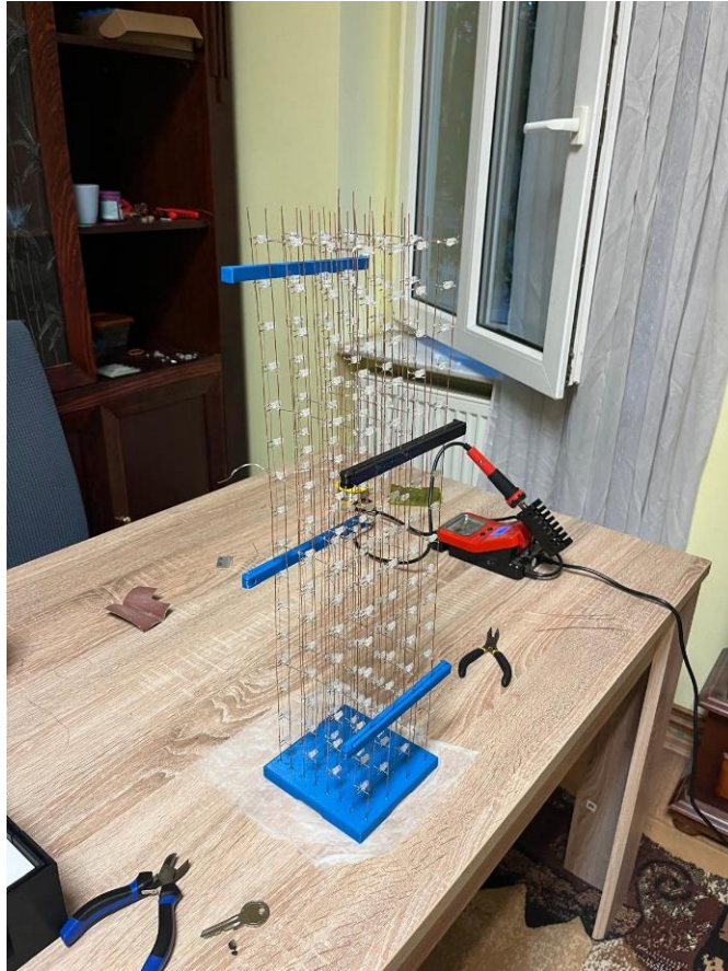
Slika 4.14. Toranj učvršćen kopčama
