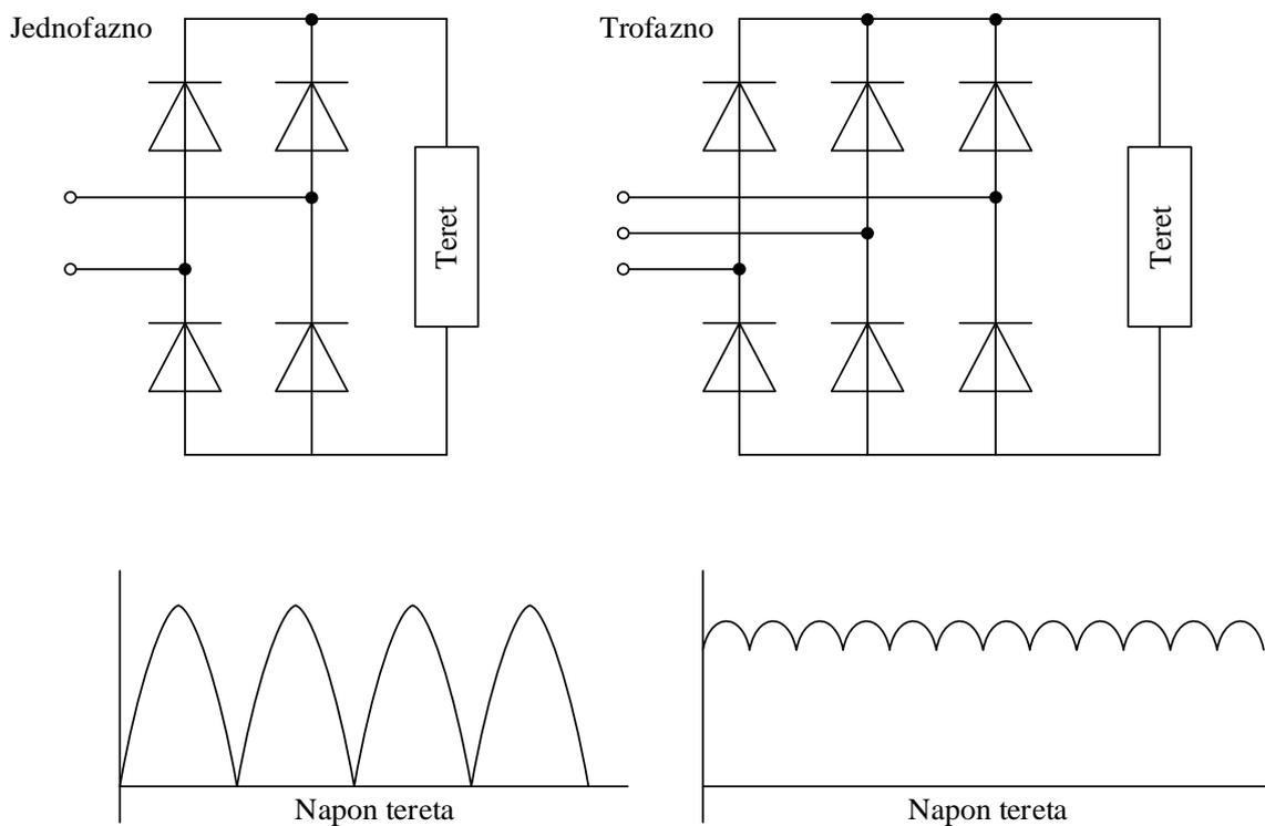
Slika 3.6. Principijelna shema jednofaznog i trofaznog ispravljača uz valne oblike napona, [6].
