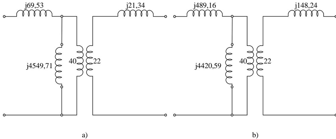
Slika 5.7. Ekvivalentne sheme, a) konvencionalni transformator, b) transformator za zavarivanje, [18].
