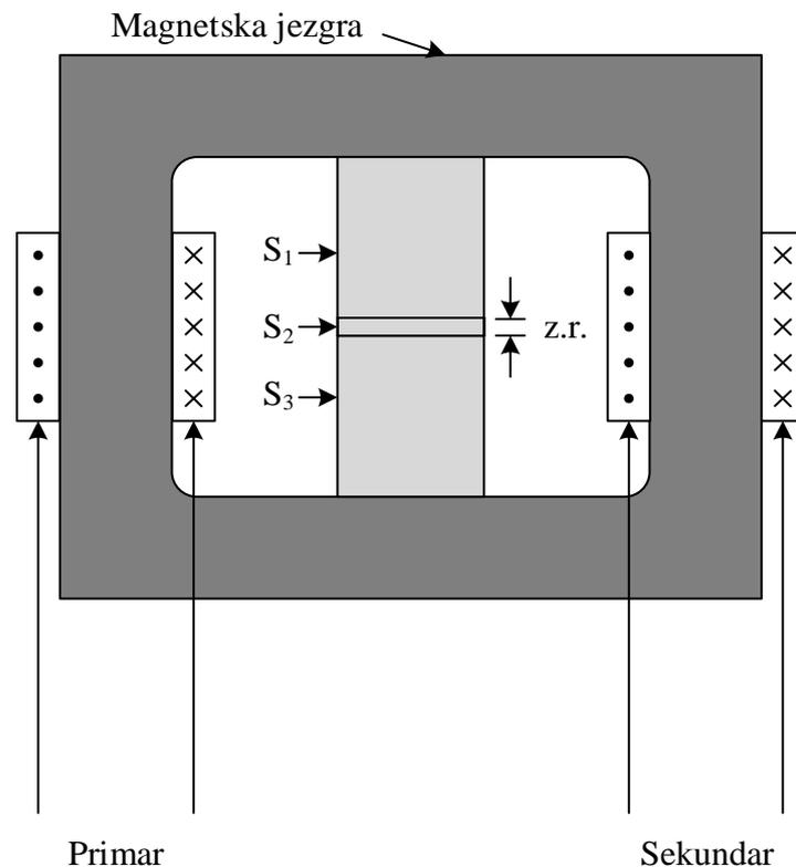
Slika 5.4. Poprečni presjek modela konačnih elemenata, [18].
