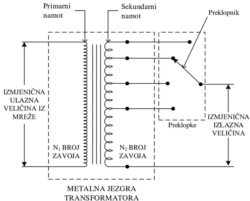
Slika 4.5. Principijelna shema transformatora za zavarivanje s preklopkama na sekundarnom namotu, [4].
