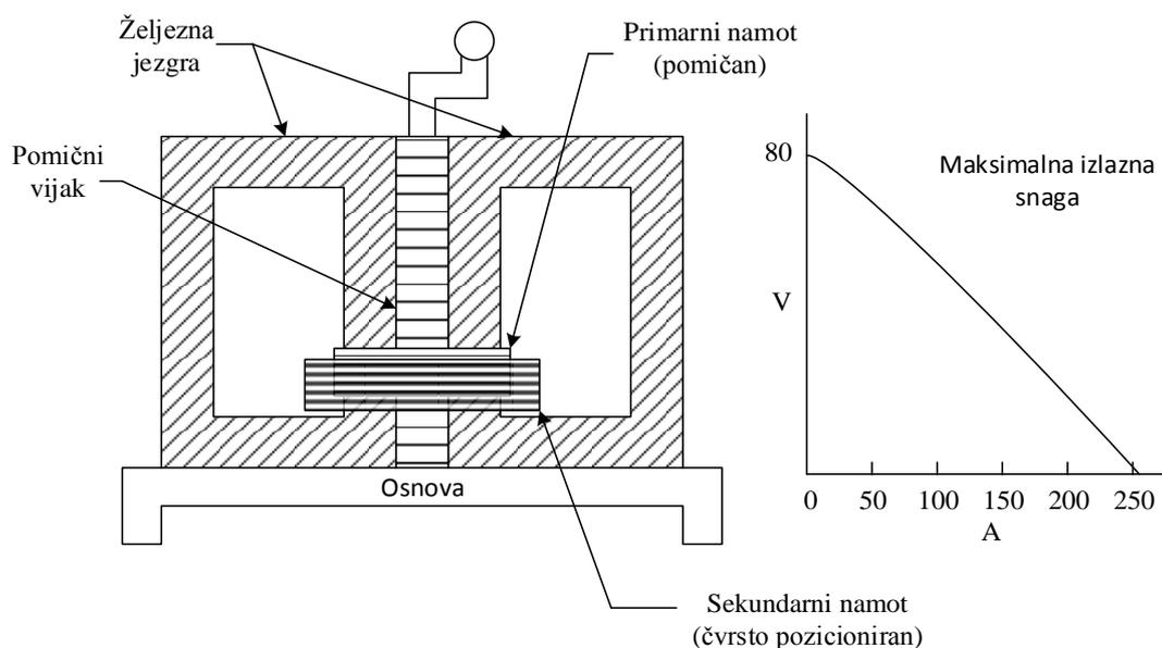
Slika 4.2. Principijelna shema transformatora s pomičnim namotom i njegova karakteristika za maksimalnu snagu, [4].
