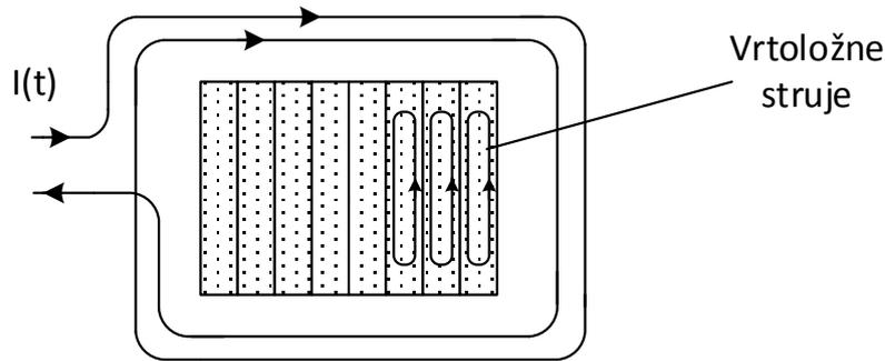
Slika 2.5. Vrtložne struje u jezgri izvedenoj od dinamolimova, [2].
