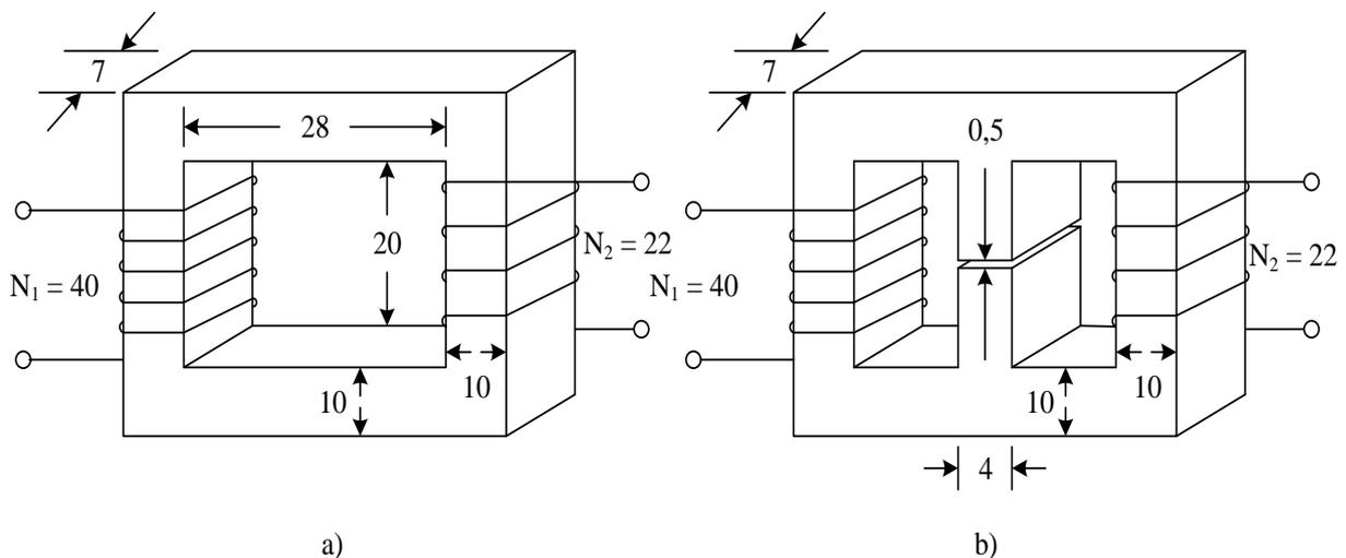
Slika 5.3. Poprečni presjeci: a) konvencionalnog transformatora; b) transformatora za zavarivanje. Dimenzije su u centimetrima, [18].
