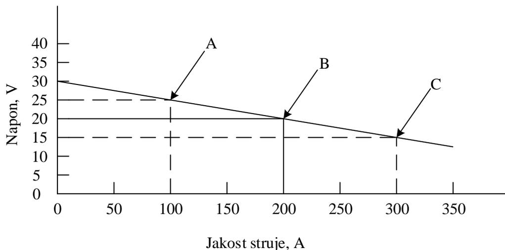
Slika 3.3. Prikaz statičke karakteristike izvora struje konstantnog napona, [4].
