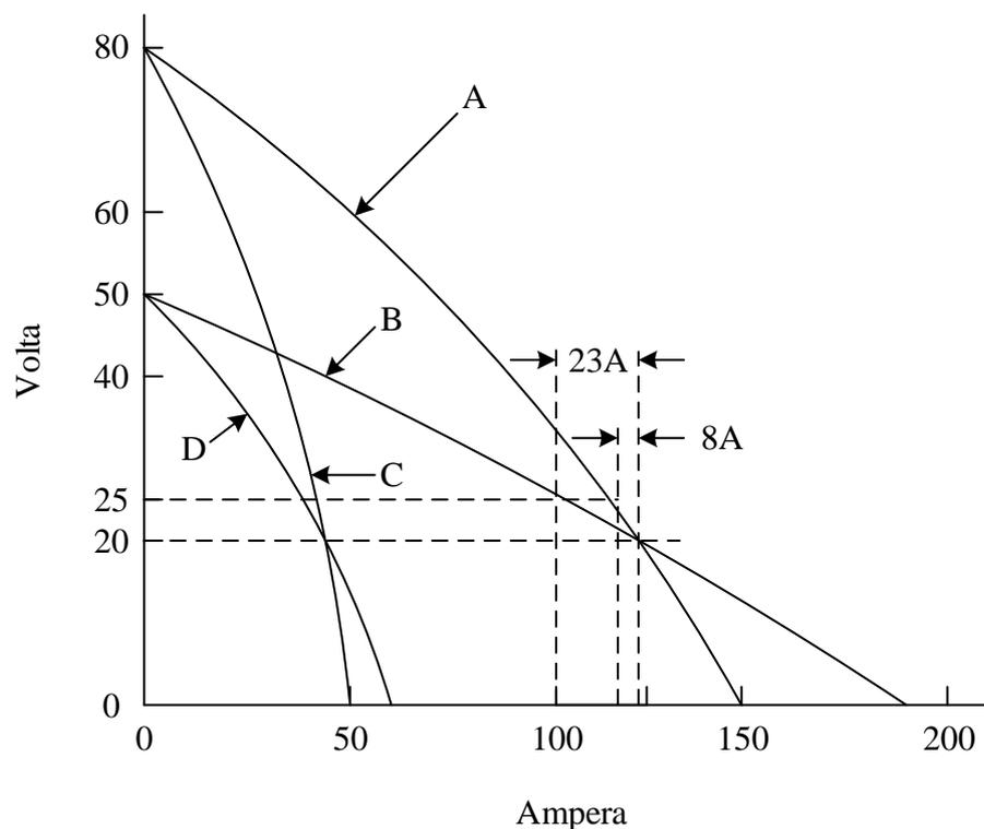
Slika 3.2. Prikaz statičke karakteristike izvora struje konstantne jakosti struje, [4].
