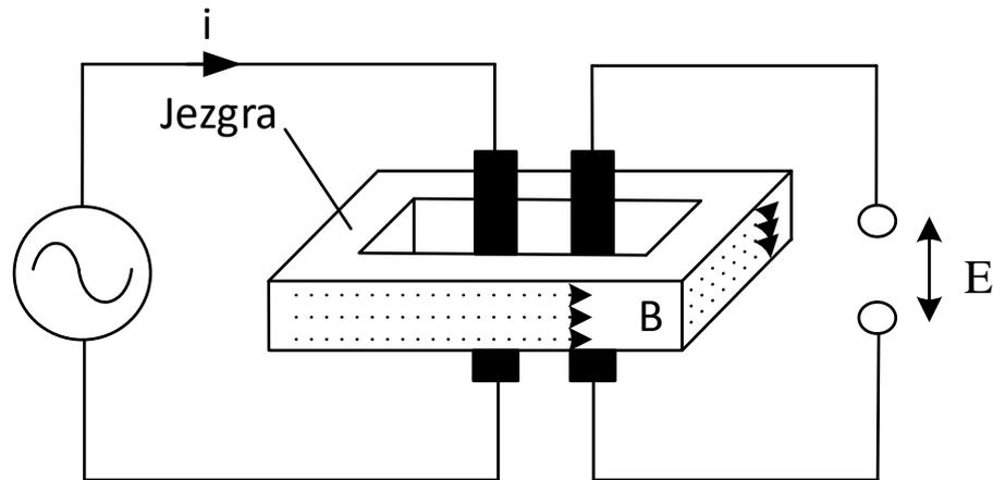
Slika 2.2. Principijelna shema induktivnog prijenosa energije s magnetskim materijalom, [1].
