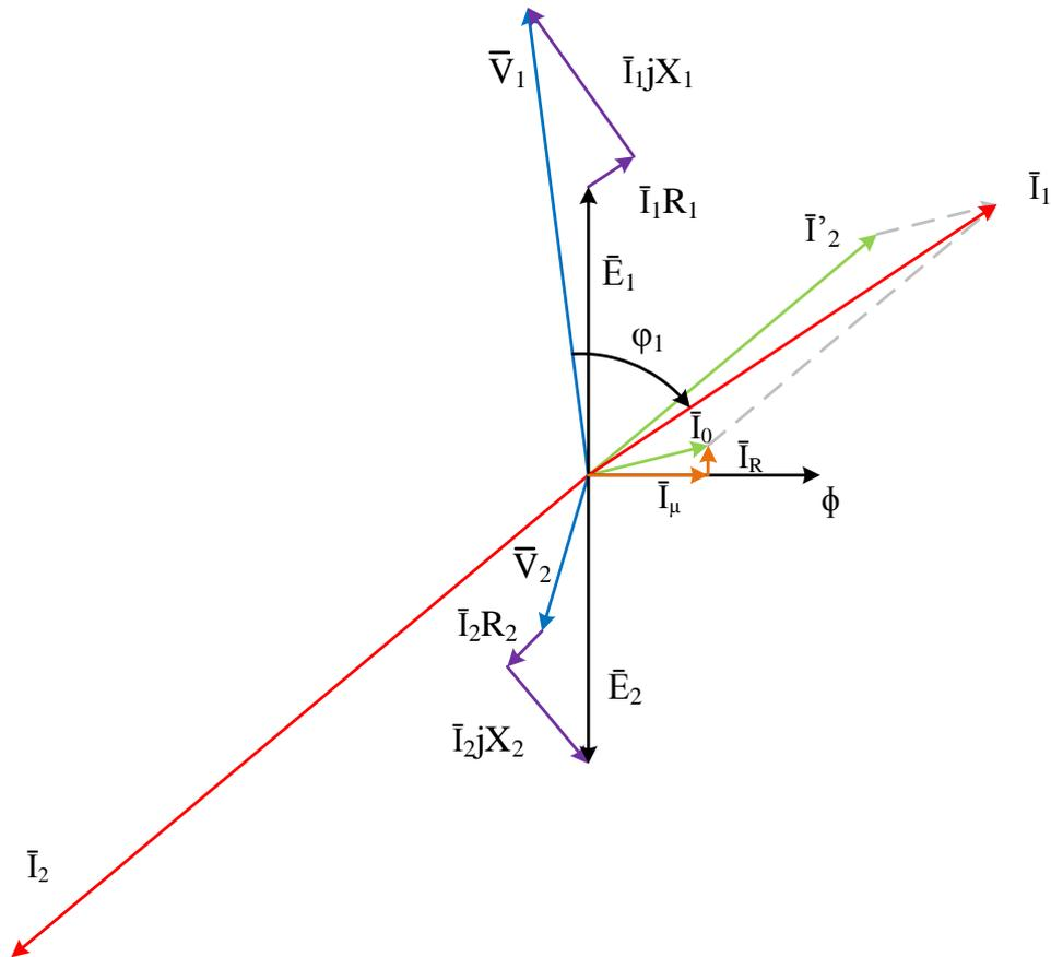
Slika 5.11. Fazorski dijagram transformatora za zavarivanje, [21].
