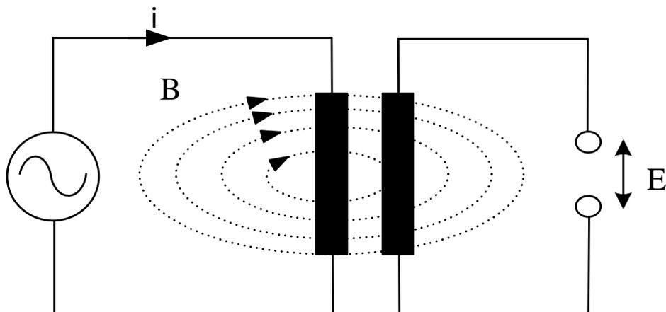
Slika 2.1. Principijelna shema induktivnog prijenosa energije, [1].
