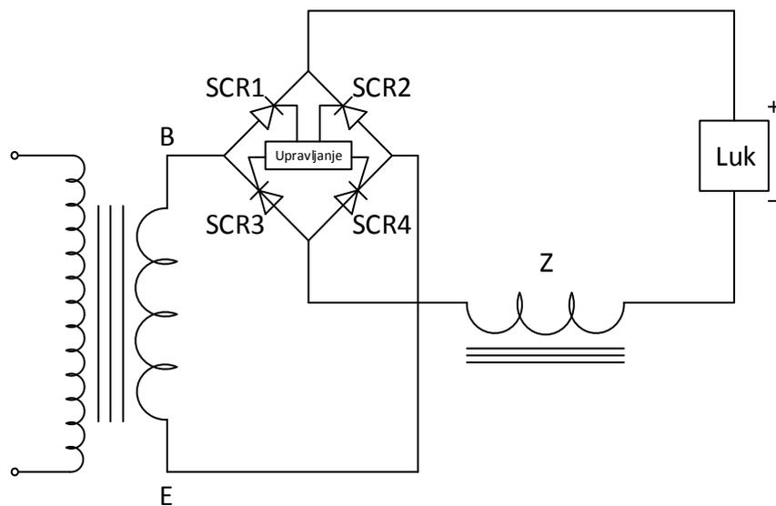
Slika 3.5. Principijelna shema jednofaznog mosnog tiristorskog ispravljača, [4].
