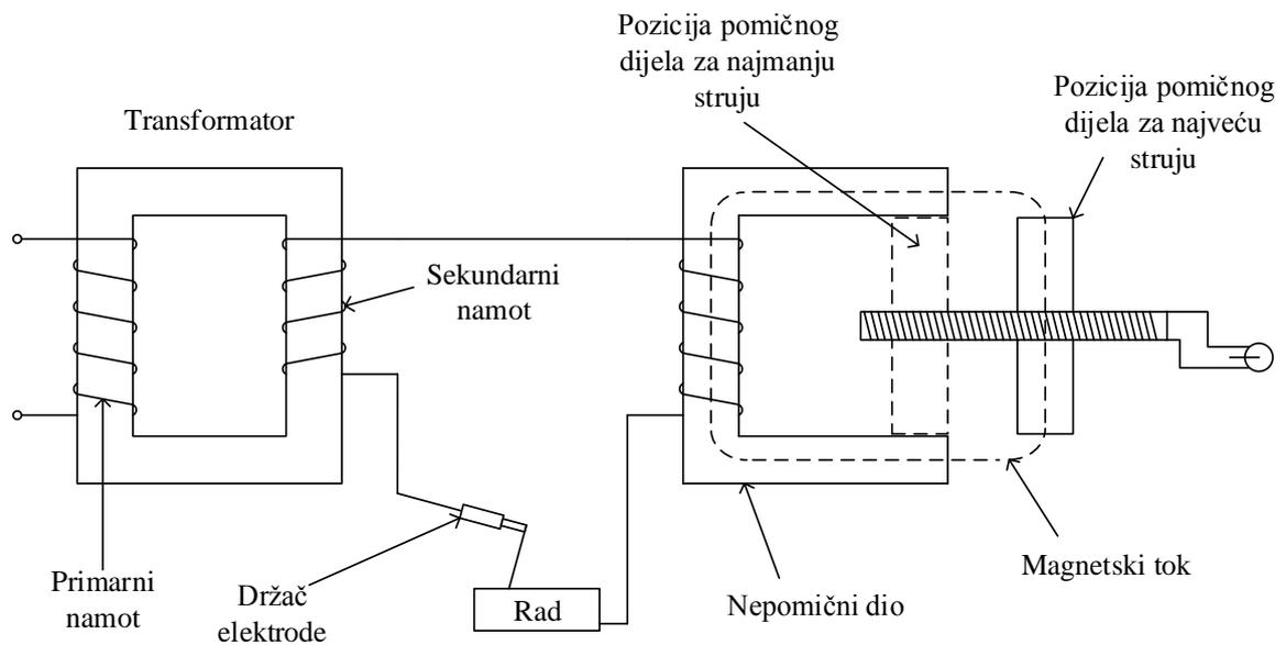
Slika 4.6. Principijelna shema transformatora i prigušnice s pomičnom jezgrom, [4].
