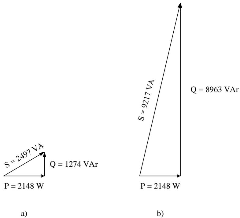
Slika 5.8. Trokut snage, a) konvencionalni transformator, b) transformator za zavarivanje.
