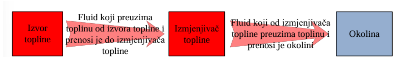
Slika 5.2. Blok shema procesa odvođenja topline od izvora topline do okoline
