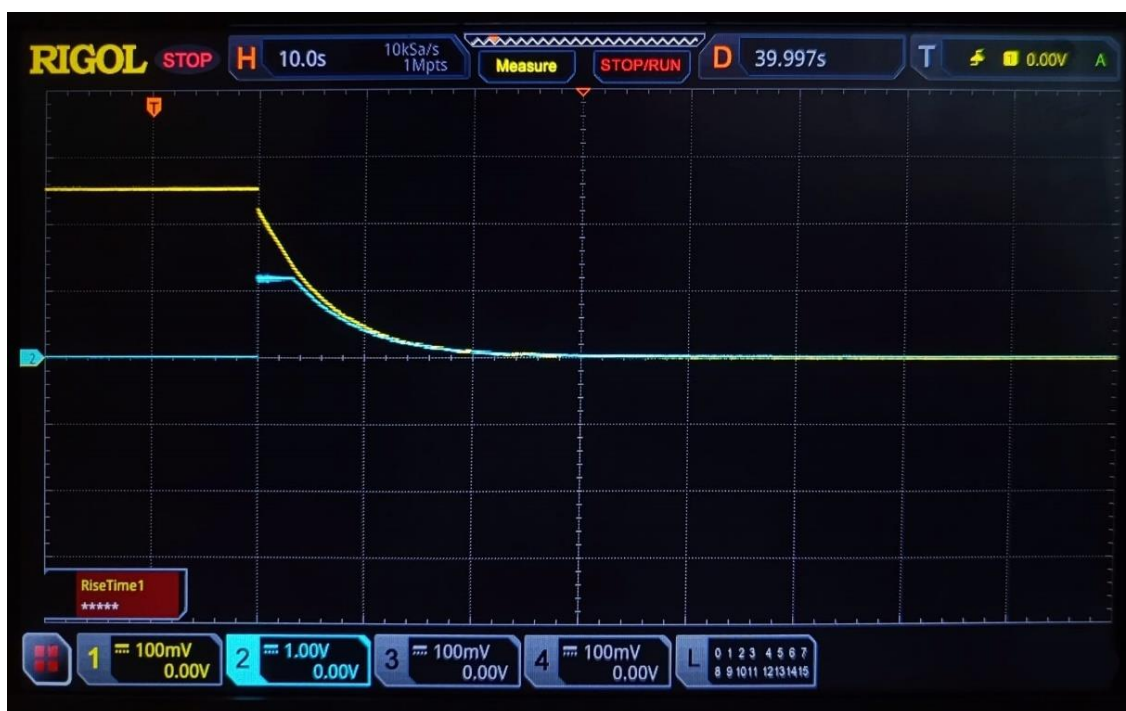
Slika 8.8. Karakteristika napona i struje za vrijeme pražnjenja superkondenzatora
