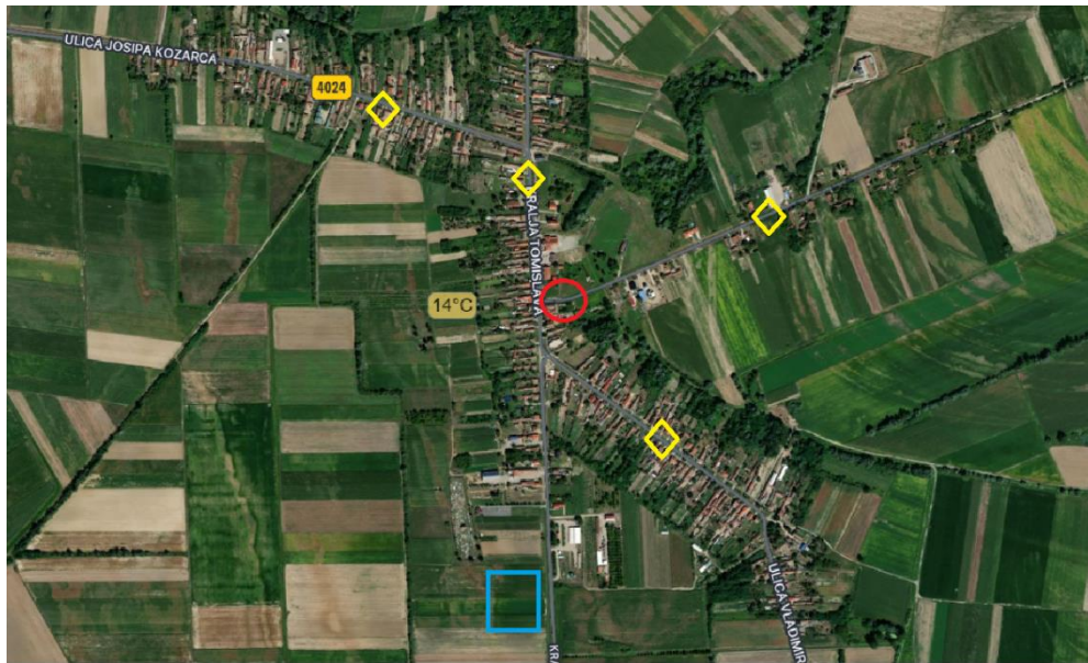
Sl. 5.1. Prijedlog postavke kolokacijskog čvora, distribucijskog čvora i lokalnih pristupnih čvorova u naselju Sopje
