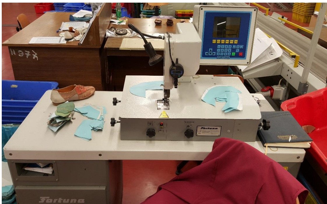
Slika 3.11. Stroj za stanjivanje CS3 Fortuna [2]
