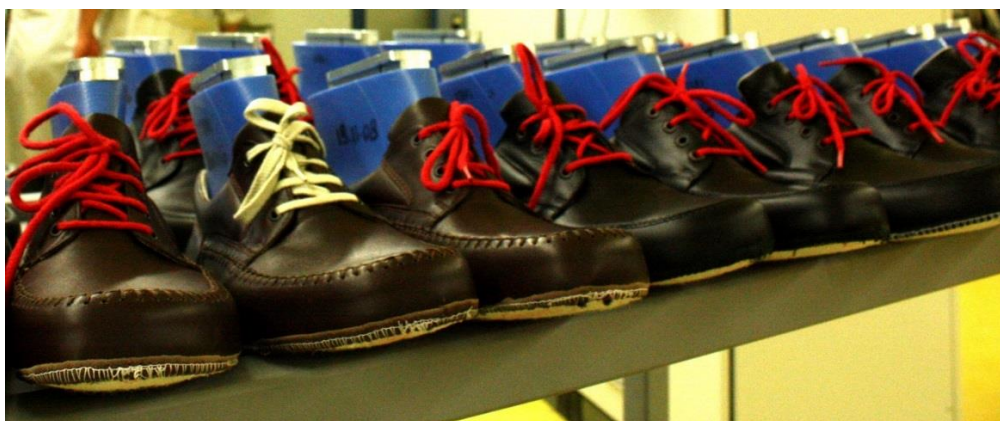
Slika 3.23. Gornjišta obuće čekaju na brizganje PU đona [2]
