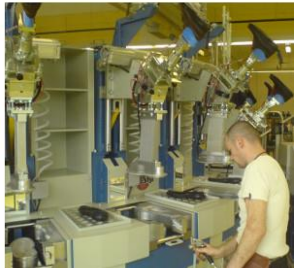
Slika 3.25. Prikaz rada stroja za brizganje poliuretana [2]
