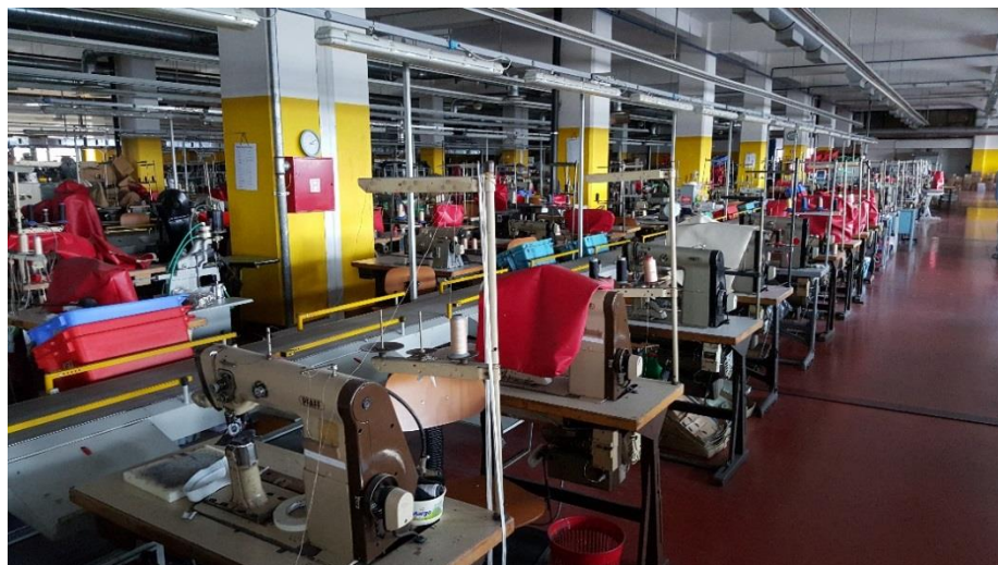
Slika 3.9. Šivaća radionica sa visokim šivaćim strojevima tip PFAFF 471 [2]
