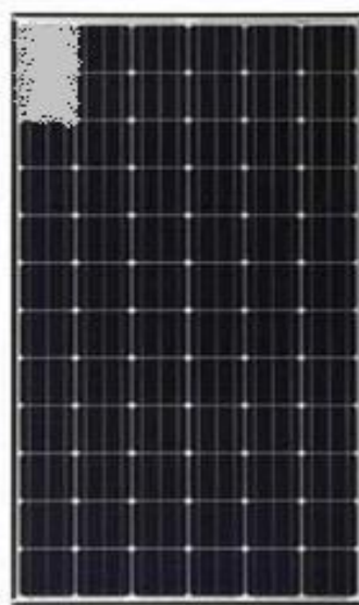
Slika 6.9. Zasjenjenje 2 ćelije FN modula Panasonic VBHN240SE10
