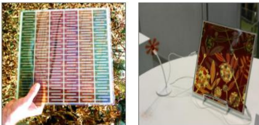
Slika 4.6. Obojane fotonaponske ćelije [16]
