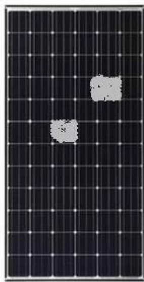
Slika 6.15. Zasjenjenje modula Panasonic VBHN240SE10 uzrokovano ptičjim izmetom
