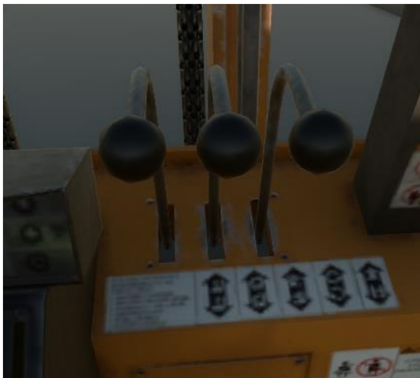
Slika 5.8. Poluge za pomicanje vilice
