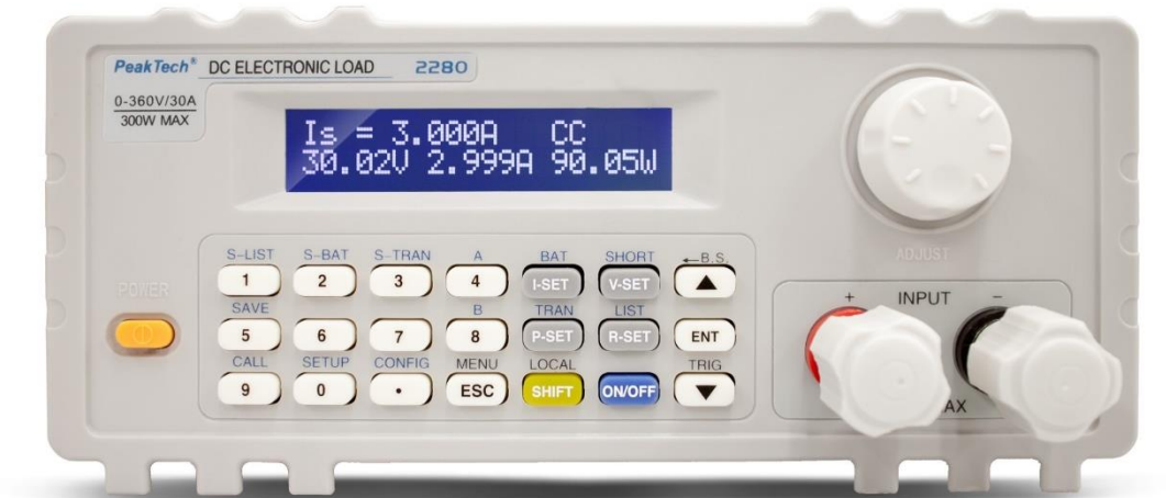
Sl. 5.10. Integrirano istosmjerno programabilno trošilo PeakTech P2280 [31]
