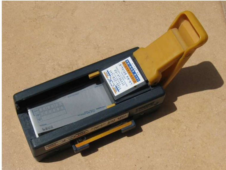
Sl. 3.1. Uređaj za otiskivanje kartica, klizač
